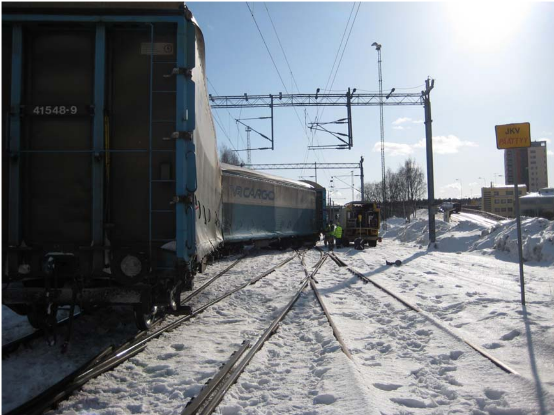
Kuva 3. Suistuneet vaunut ennen raivauksen aloittamista. (Kuva: VR Cargo)
