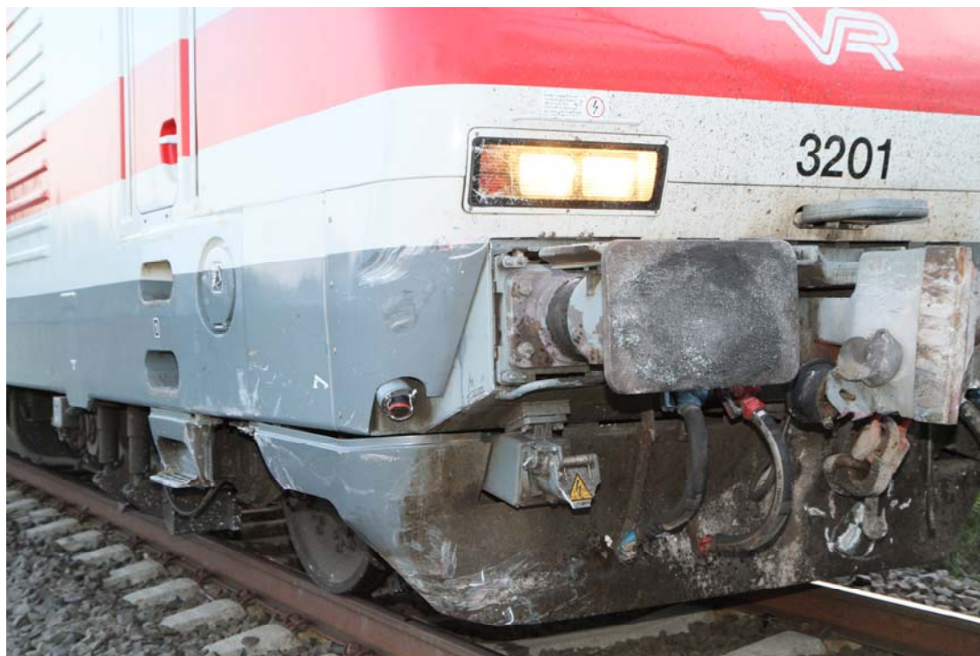
Kuva 2. Veturi vaurioitui lähinnä oikeasta etukulmastaan. (kuva poliisi)
