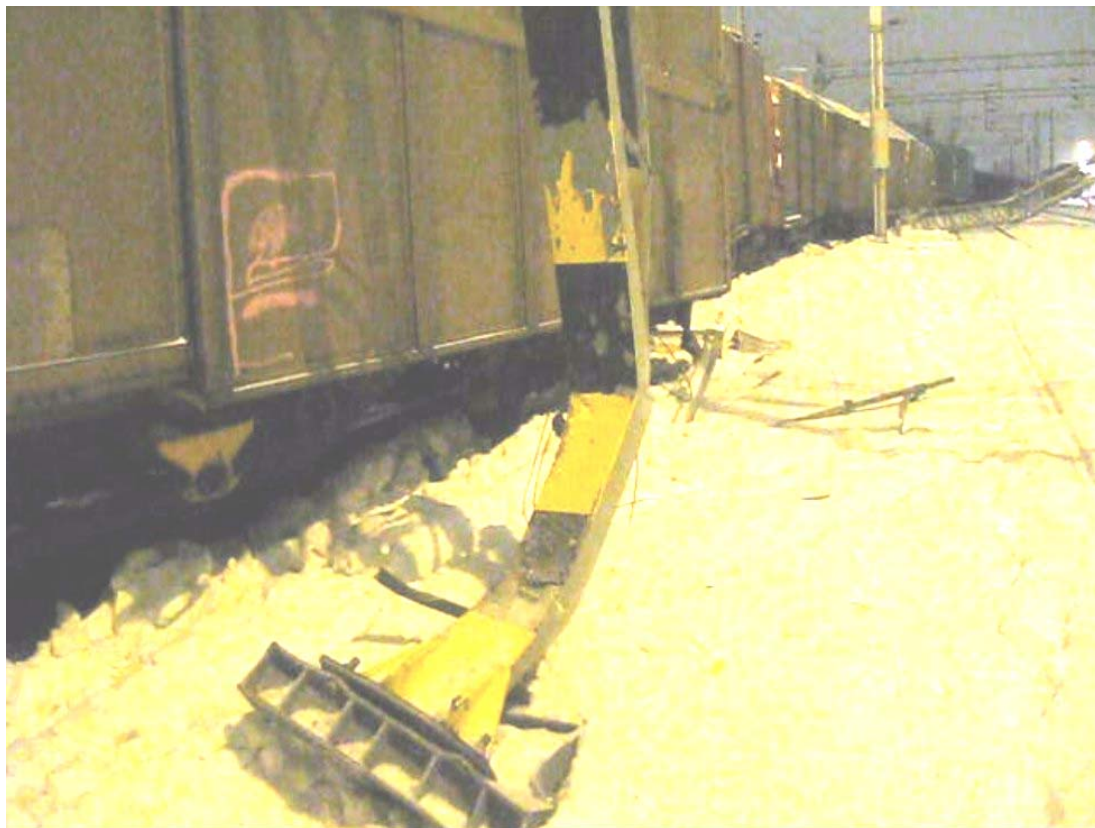
Kuva 3. Suistuneita vaunuja sekä vaurioituneet sähköratapylväs ja portaali.
