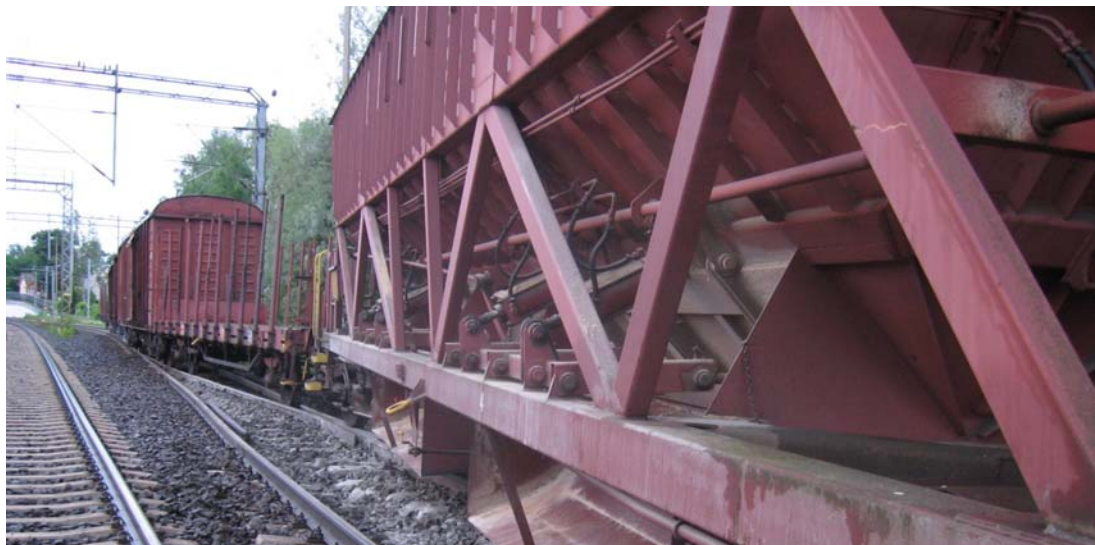
Kuva 3. Osa vaunuista ohjautui vaihteessa V004 turvaraitteelle. Kuvassa oikealla junan 25. vaunu.
