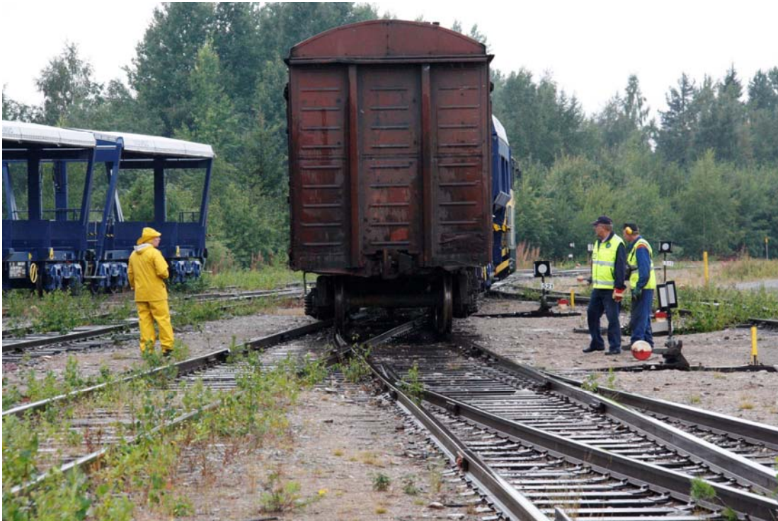
Kuva 23. Onnettomuudessa kaatuneiden 17. ja 18.vaunun koeajo.
