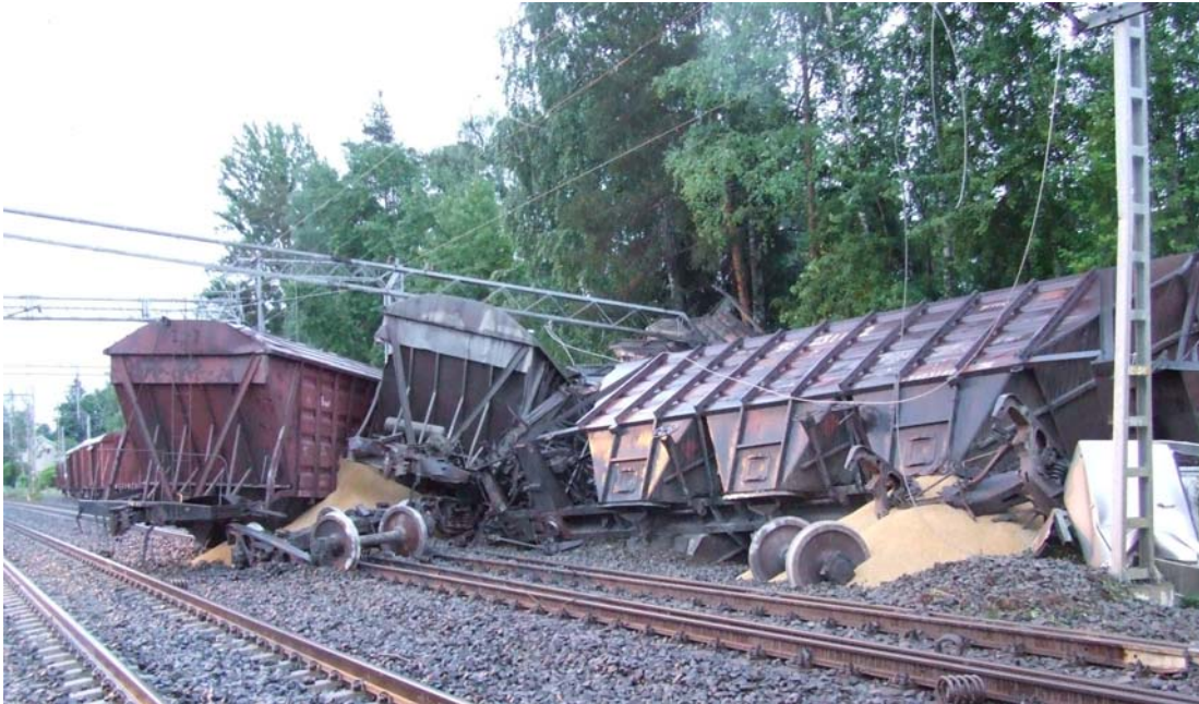
Kuva 5. Turvaraitteen raidepuskimen läpi menneet vaunut. (Kuva Eltel)
