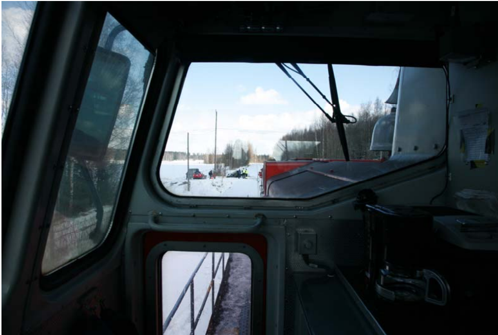
Kuva 6. Vaihtotyönjohtaja istui ohjaamon vasemmalla puolella, jolloin moottorin suoja rajoitti havaintojen tekoa oikealle.
