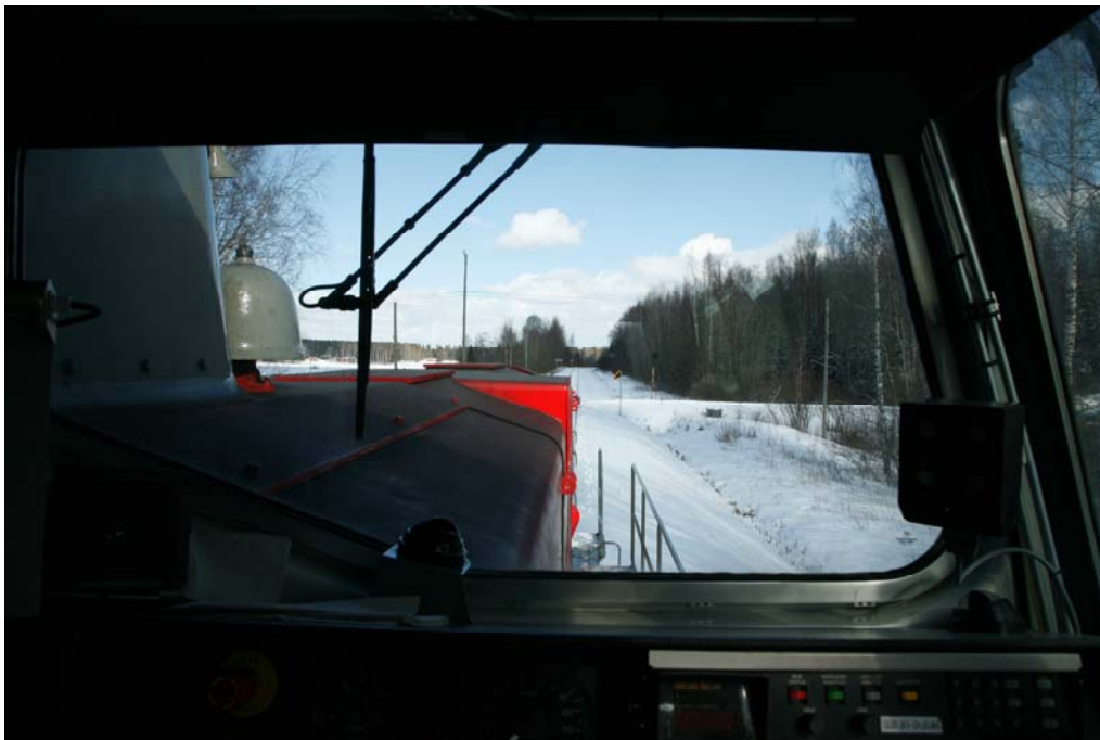
Kuva 5. Veturin päämoottorin suoja rajoitti veturinkuljettajan havaintojen tekoa vasemmalle eli pakettiauton tulosuuntaan.
