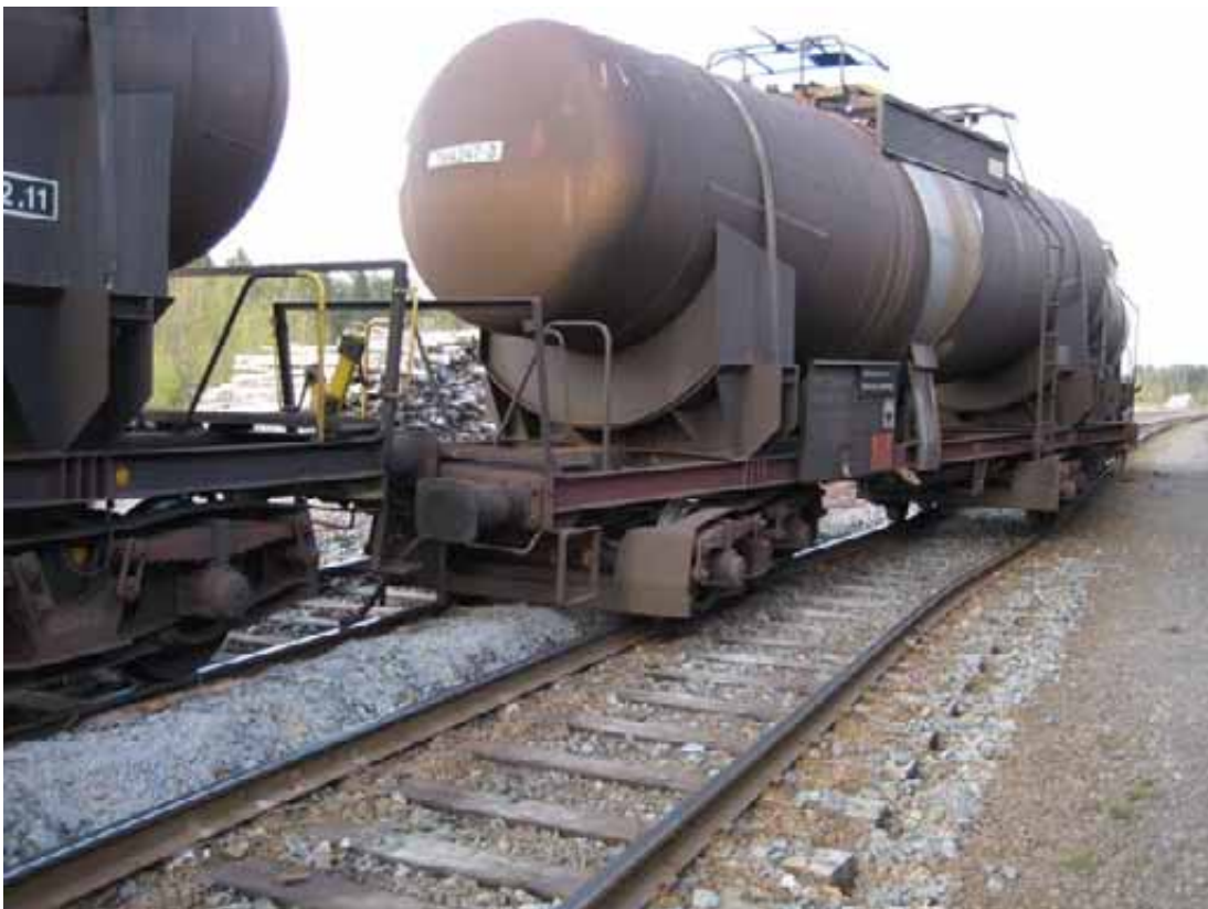
Kuva 3. Suistunut vaunu (kuva VR-raivauspäällikkö).
