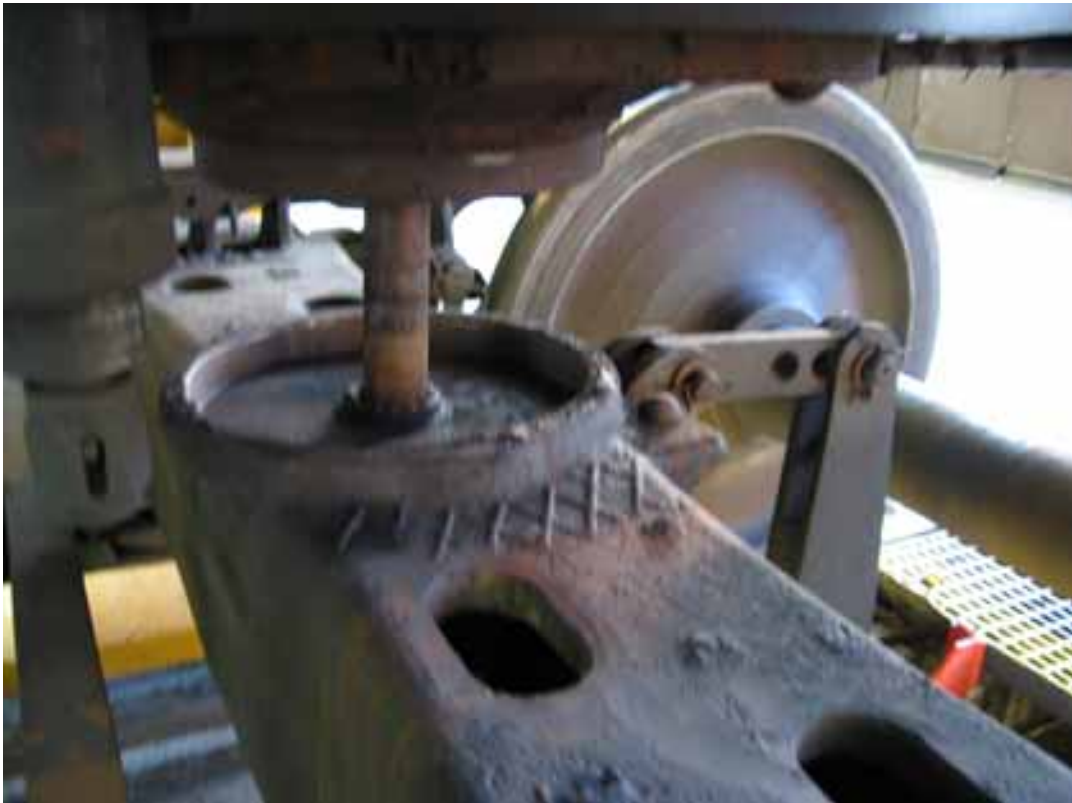
Kuva 5. Ensimmäisen suistuneen venäläisen säiliövaunun telikeskiöt olivat kuivat. Rasvaa oli vain telinpuoleisen osan reunoilla.
