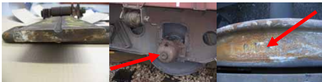
Kuva 2. Vaunusta pudonneen jousipakan katkennut jousi, vaurioitunut laakeripesä, jossa rikkoutunut laakeri oli ja pyörässä ollut lovi. Keskimmaisessä kuvassa näkyy myös jousipakan puuttuminen.
