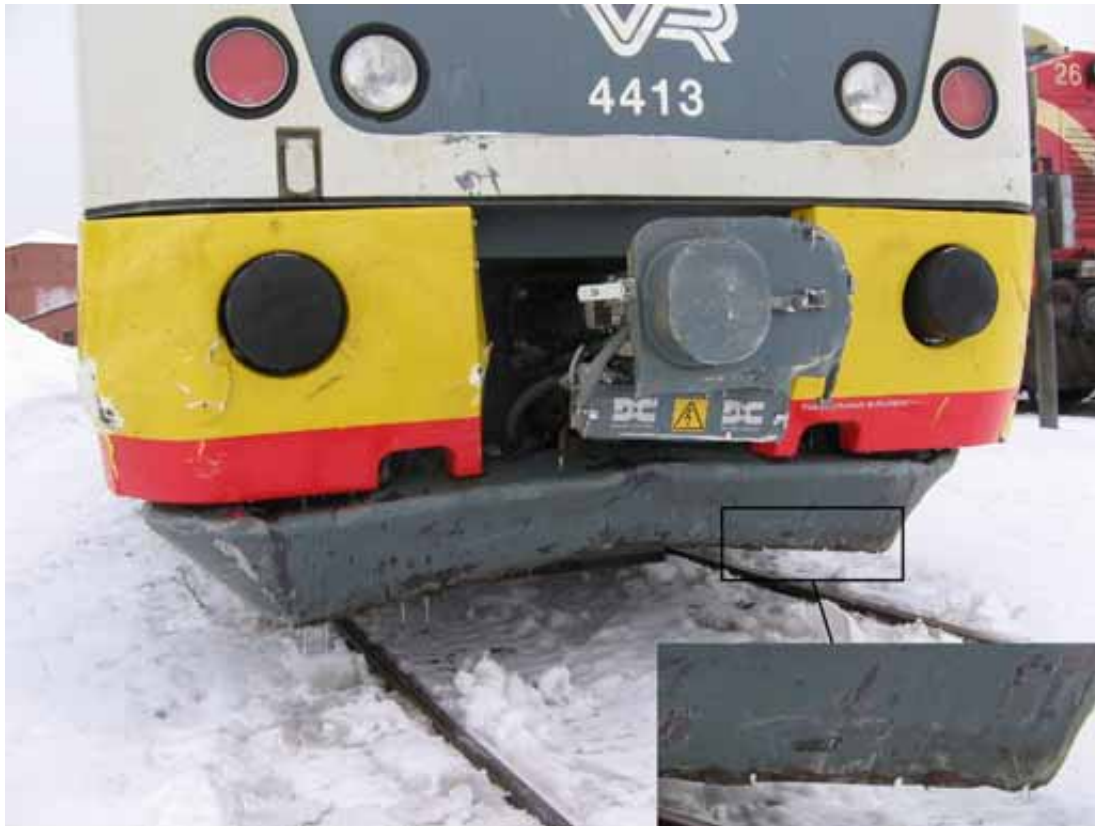
Kuva 3. Junan vauriot törmäyksen jälkeen. Karja-auran alareunassa näkyy revenneitä alaosan kiinnityskohtia.
