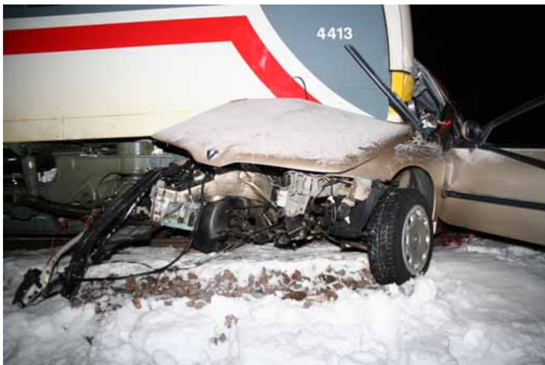
Kuva 4. Auton korirakenteet painuivat törmäyksessä kasaan.
