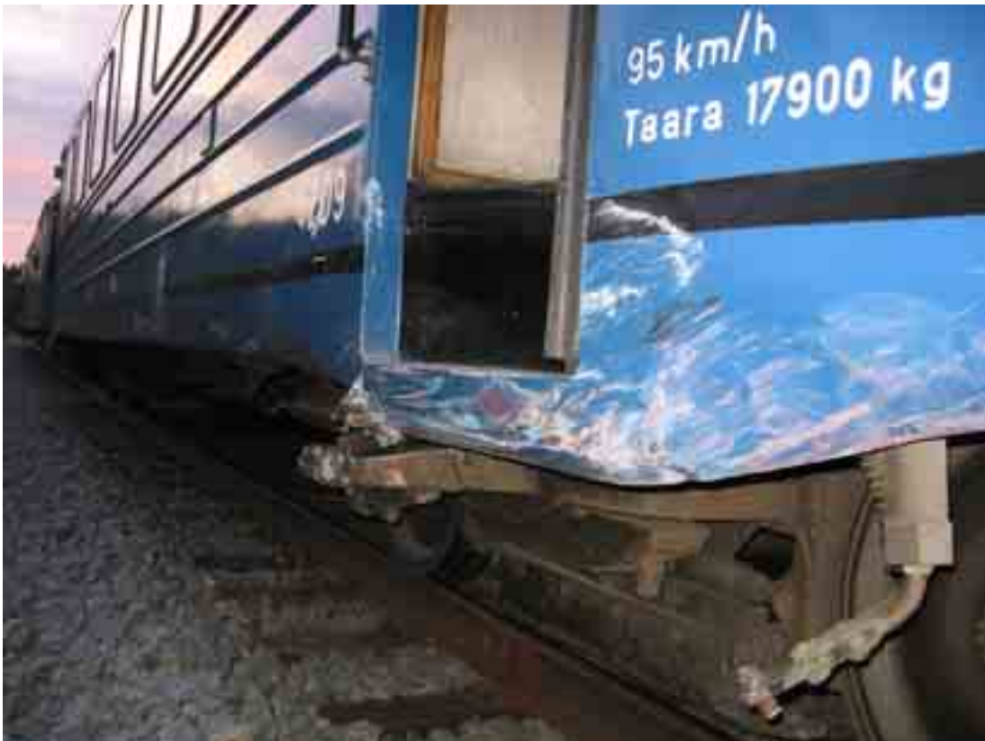
Kuva 29. Moottorivaunun vaurioitunut etukulma (kuva poliisi).
