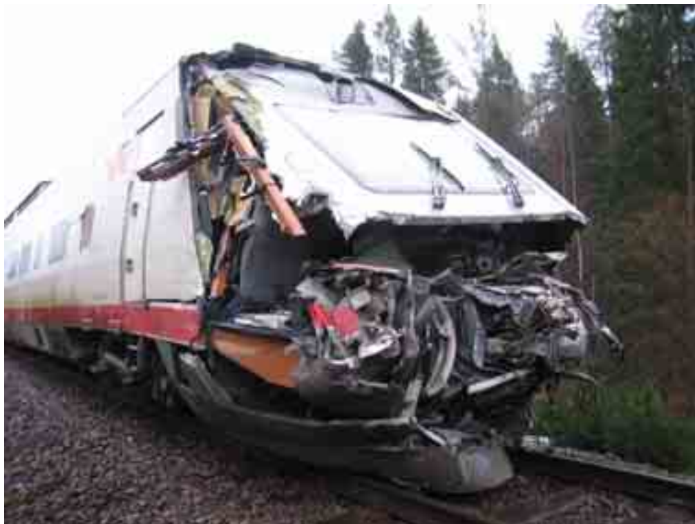
Kuva 6. Junan keula törmäyksen jälkeen.
