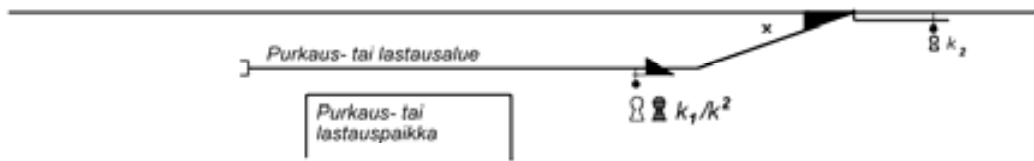
Kuva 6.3:3 Laitteistoriippumaton purkaus- ja lastauspaikan varmistuslukkolaitos
