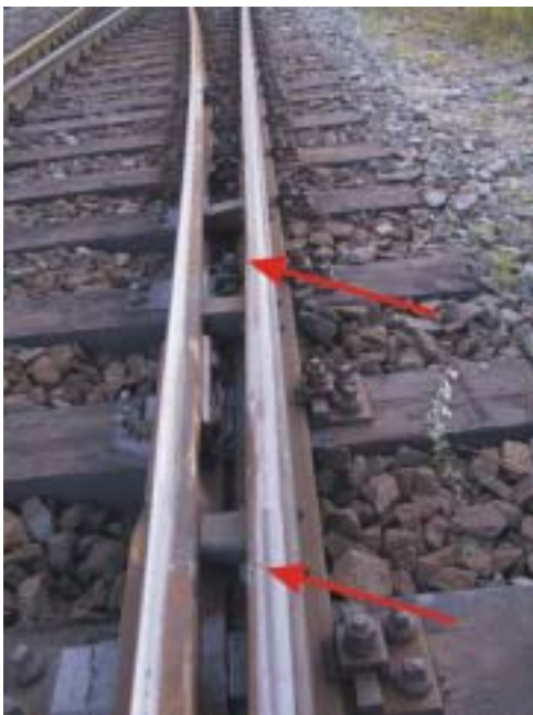
Kuva 8. Oikeanpuoleiset pyörät lähtivät putoamaan 5,4 metrin päässä (lähempi punainen nuoli) ja putosivat 7,0 metrin päässä kielen kärjestä (vasen kuva). Putoamiskohta myös oikean puoleisessa kuvassa.
