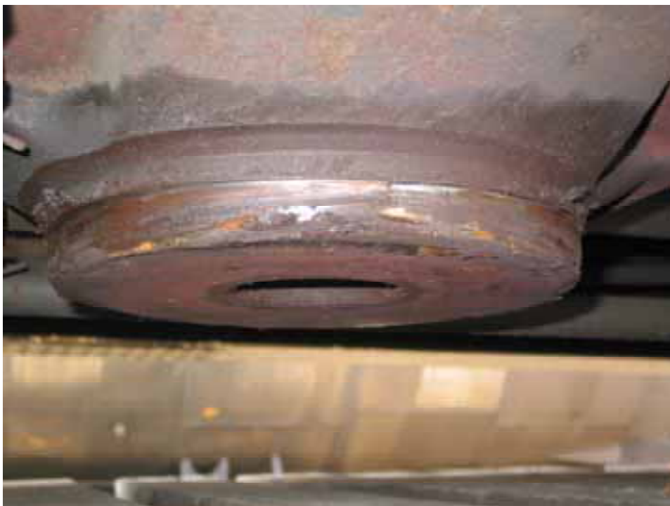
Kuva 5. Suistuneen ja kaatuneen venäläisen vaunun telikeskiön yläosa (6. vaunu).
