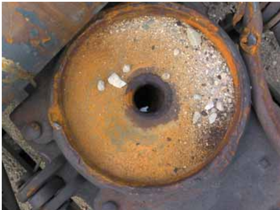
Kuva 6. Suistuneen ja kaatuneen venäläisen vaunun telikeskiön yläosa (6. vaunu).
