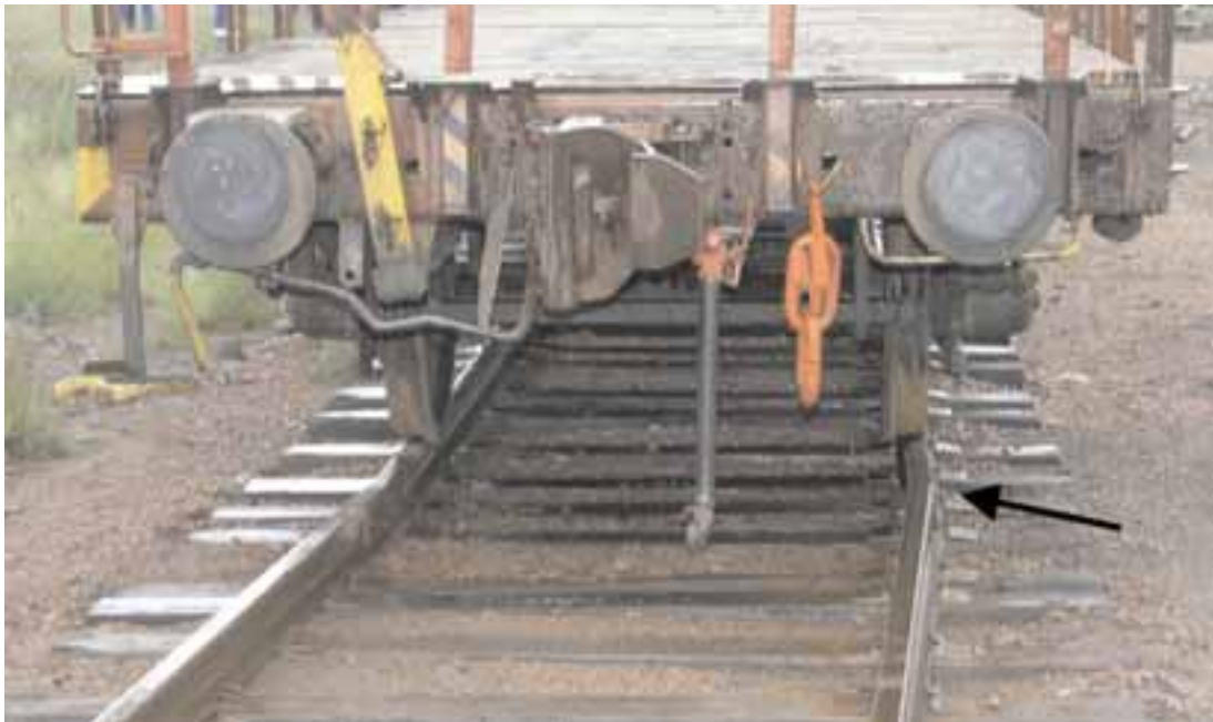
Kuva 4. Kiskoilla pysynyt vaunu onnettomuusraiteella 208. Kiskonjatkoksessa näkyy jyrkkä sivupiikki.
