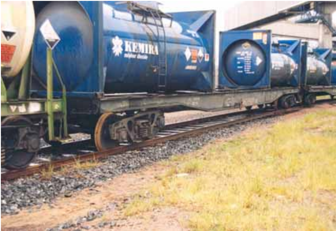
Kuva 5. Kahden venäläisen rikkidioksidikonteilla kuormatun konttivaunun suistuminen kiskoilta Harjavallassa 7.6.2004. Kokonaan suistunut vaunu kuvan keskellä, oikealla toisen vaunun suistunut etuteli.
