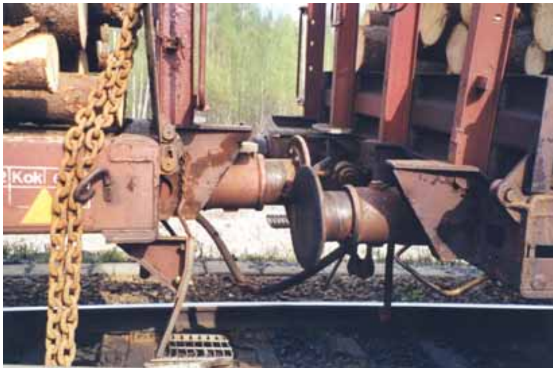
Kuva 3. Ristissä olevat puskimet 22:sen ja 23:nen vaunun välissä.
