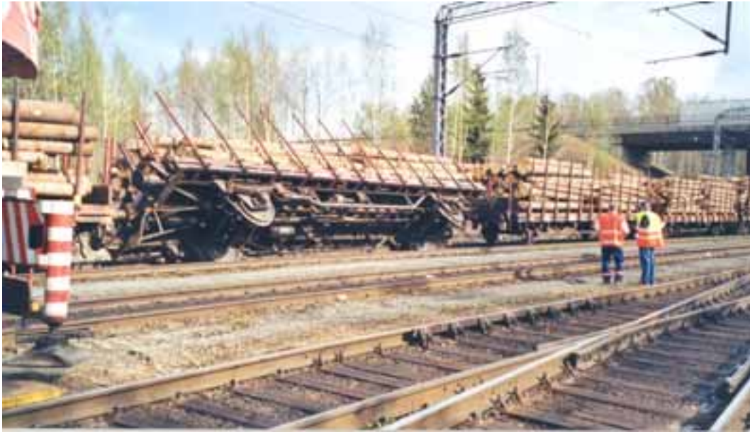
Kuva 6. Suistunut ja kallistunut vaunu.
