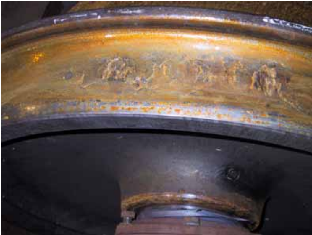
Kuva 4. Matkustajavaunun laakerin kuumakäynnistä aiheutunut vaaratilanne Hankasalmella 30.1.2002. Pyörässä ollut rakkulamuodostelma.
