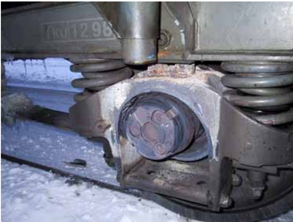
Kuva 2. Matkustajavaunun laakerin kuumakäynnistä aiheutunut vaaratilanne Hankasalmella 30.1.2002. Vaurioitunut laakeri paikallaan vaunussa.
