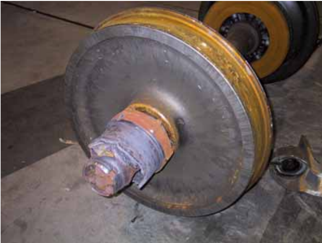
Kuva 3. Matkustajavaunun laakerin kuumakäynnistä aiheutunut vaaratilanne Hankasalmella 30.1.2002. Vaurioitunut laakeri avattuna varikolla.
