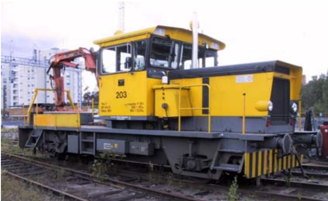
Kuva 5. Junasuorittajan loukkaantuminen vaihtotyössä Enossa 17.8.2001. Uudemmanmallinen Tka7, jossa on porrastikkaat päädyissä. Keskellä on edelleen pystysuorat tikkaat.
