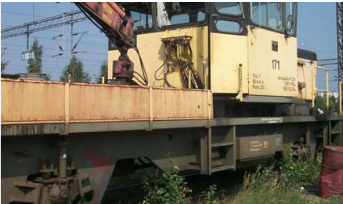
Kuva 3. Junasuorittajan loukkaantuminen vaihtotyössä Enossa 17.8.2001. Ratakuorma-auto Tka7 ja sen tasoaskelmin varustetut tikkaat, joilta junasuorittaja putosi.
