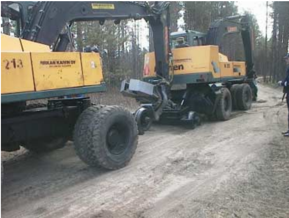
Kuva 2. Kaivinkoneiden yhteentörmäys Vihannin ja Tuomiojan välillä 7.5.2001. Onnettomuudessa mukana olleet ratapölkkyjen vaihdossa käytettävät kiskopyörillä varustetut kaivinkoneet.
