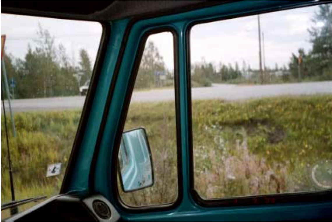
Kuva 9. Onnettomuus lissä Akolan vartioimattomassa tasoristeyksessä 9.2.2000. Kuva onnettomuusautoa vastaavan pakettiauton ohjaamosta. Tuulilasin ja siviikkunan välinen pilari on saattanut onnettomuustilanteessa haitata näkemistä junan tulosuuntaan.
