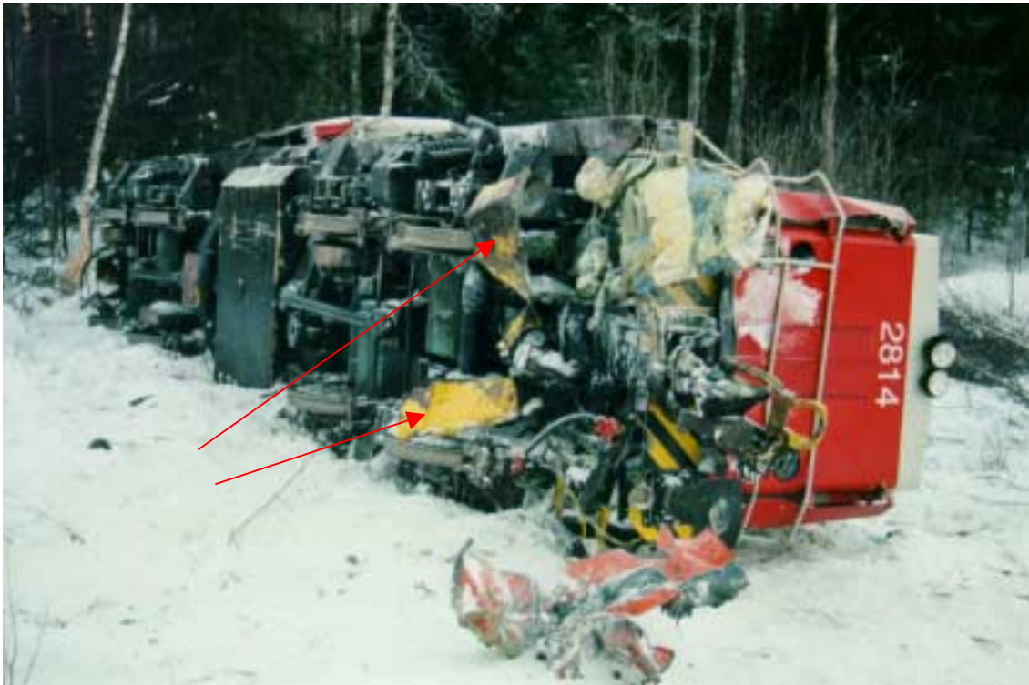
Kuva 2. Onnettomuus lissä Akolan vartioimattomassa tasoristeyksessä 9.2.2000. Veturi kaatui vasemmalle kyljelleen keula tulosuuntaan. Veturin rikkoutunut esteenraivaaja merkitty nuolella. Edessä autosta irronnutta peltiä. Oikeassa puskimessa rikkoutunut öljytynnyri.
