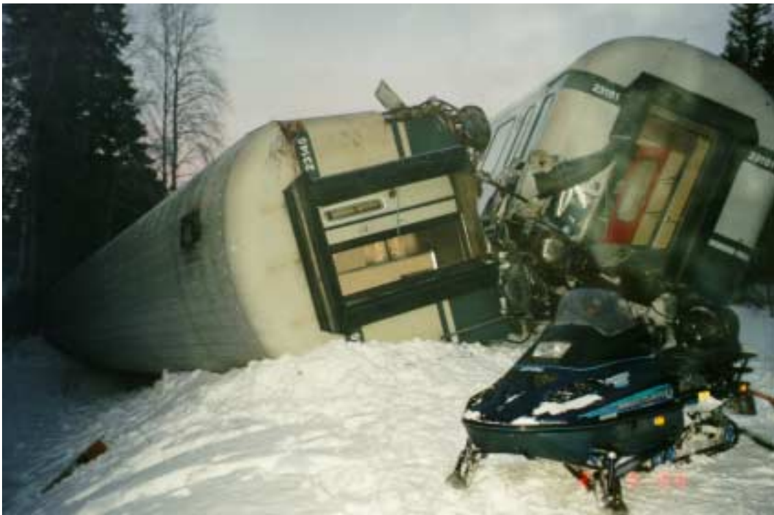
Kuva 4. Onnettomuus lissä Akolan vartioimattomassa tasoristeyksessä 9.2.2000. Ensimmäinen ja toinen vaunu olivat kiinni toisissaan ruuvikytkimellä vielä ensimmäisen vaunun kaaduttuakin.
