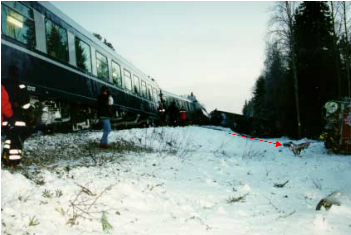
Kuva 3. Onnettomuus lissä Akolan vartioimattomassa tasoristeyksessä 9.2.2000. Kuva junan oikealta sivulta. Ensimmäisen vaunun etuteli jäi nuolen osoittamaan paikkaan.
