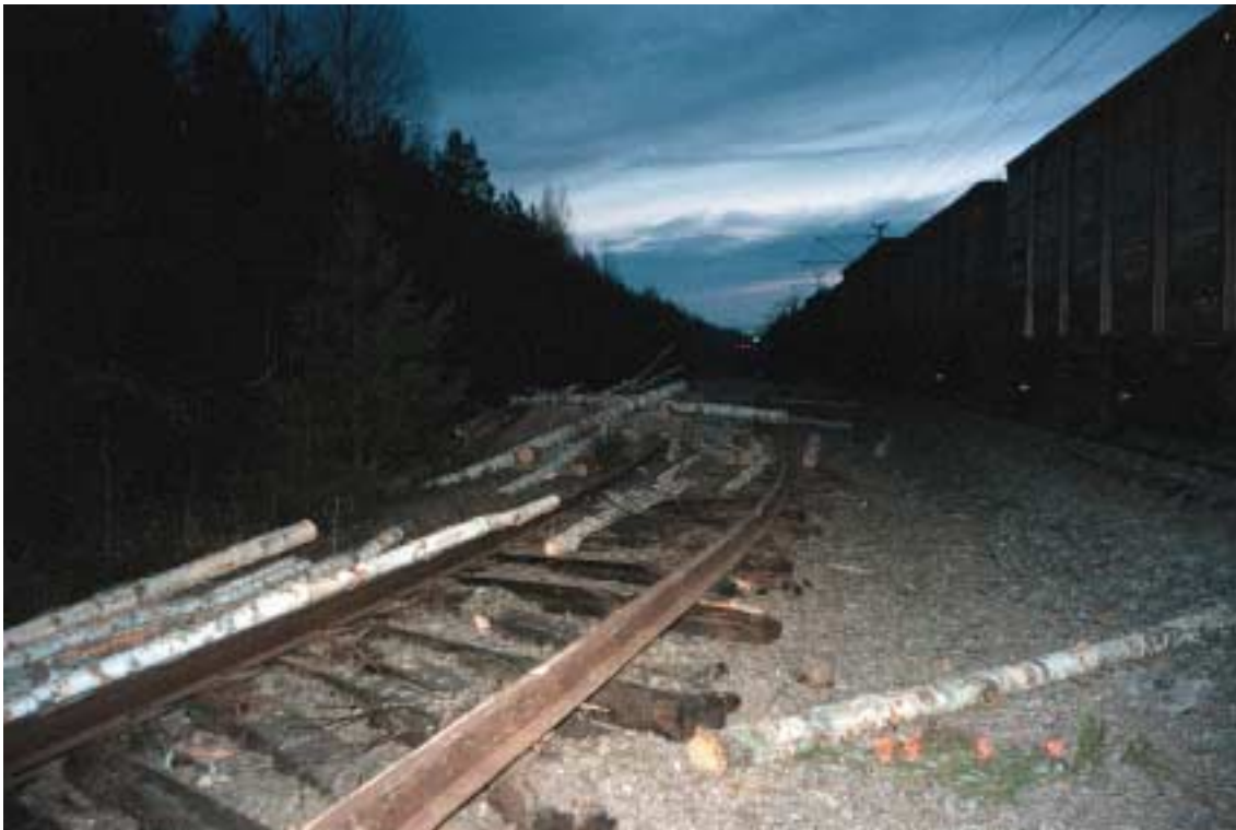
Kuva 5. Puutavaravaunujen suistuminen Multamäellä 4.5.1999. Vaunu rikkoi suistuessaan Multamäen ratapihan eteläpään turvaraiteen ja sen raidepuskimen. Lisäksi vaunu ylitti kilometripylvään ja suojastusopastimen.
