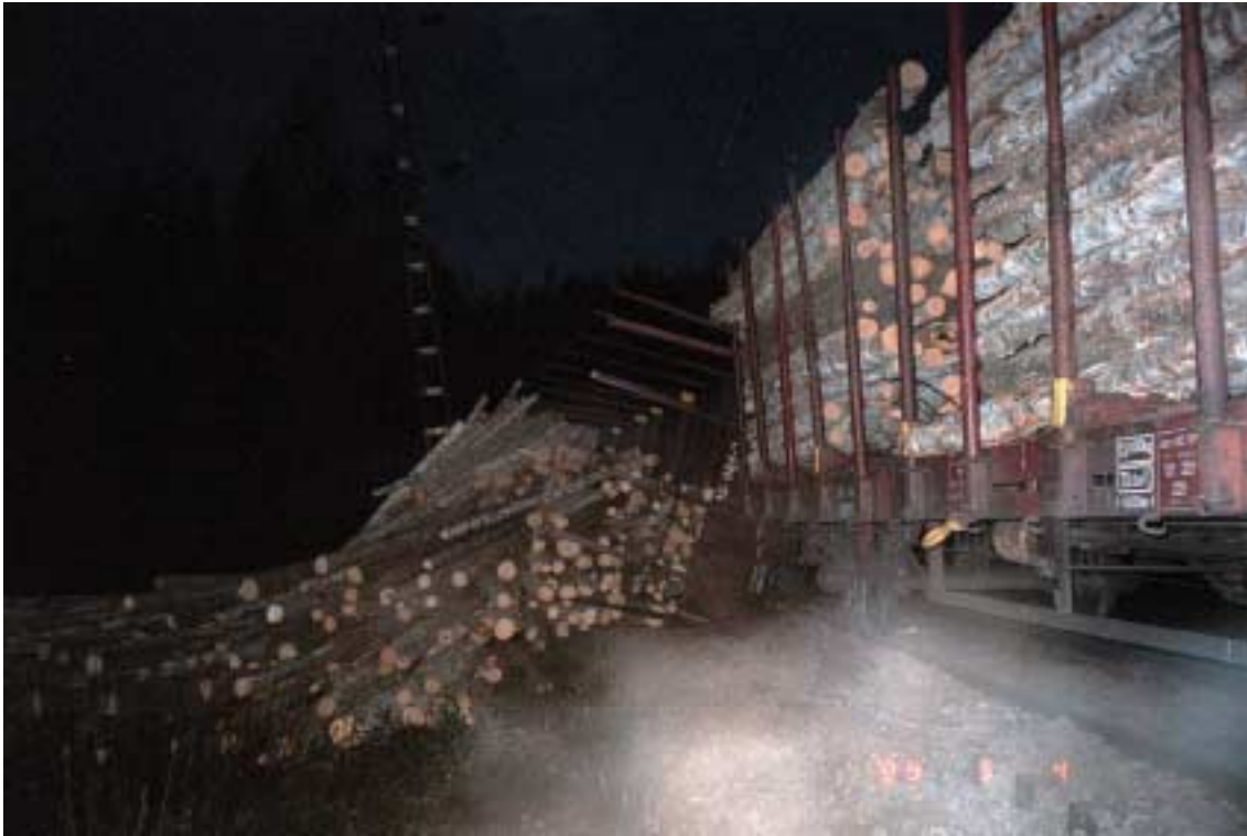
Kuva 6. Puutavaravaunujen suistuminen Multamäellä 4.5.1999. Seuraava vaunu suistui radan vasemmalle puolelle ja jäi kallelleen sähköradan kannatinpylvästä vasten. Muut vaunut pysyivät kiskoilla.
