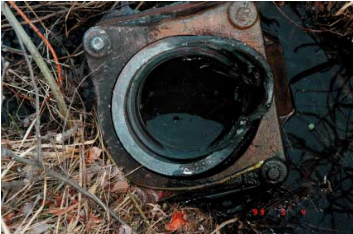
Kuva 3. Puutavaravaunujen suistuminen Multamäellä 4.5.1999. Laakeripesä vieri ratapenkereen alapuolella olevaan ojaan.
