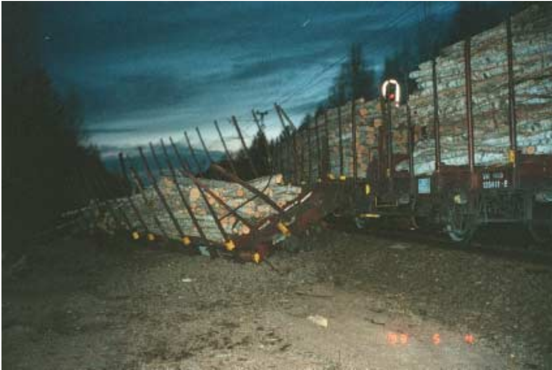
Kuva 4. Puutavaravaunujen suistuminen Multamäellä 4.5.1999. Vaunun oikea etupyörä ylitti kiskon ja vaunu suistui radan oikealle puolelle 9,5 km:n päässä akselin katkeamispaikasta.
