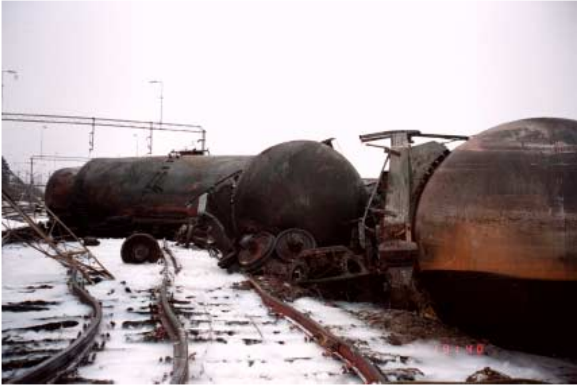
Kuva 9. Säiliövaunujen suistuminen kiskoilta ja palo Vainikkalassa 7.4.1999. Kuvattu edestä päin. Vasemmalta lukien 23., 22., 21. ja 19 vaunu sekä purkautuneita te- lejä. Vasemmalla alas pudonnut portaalin orsi.
