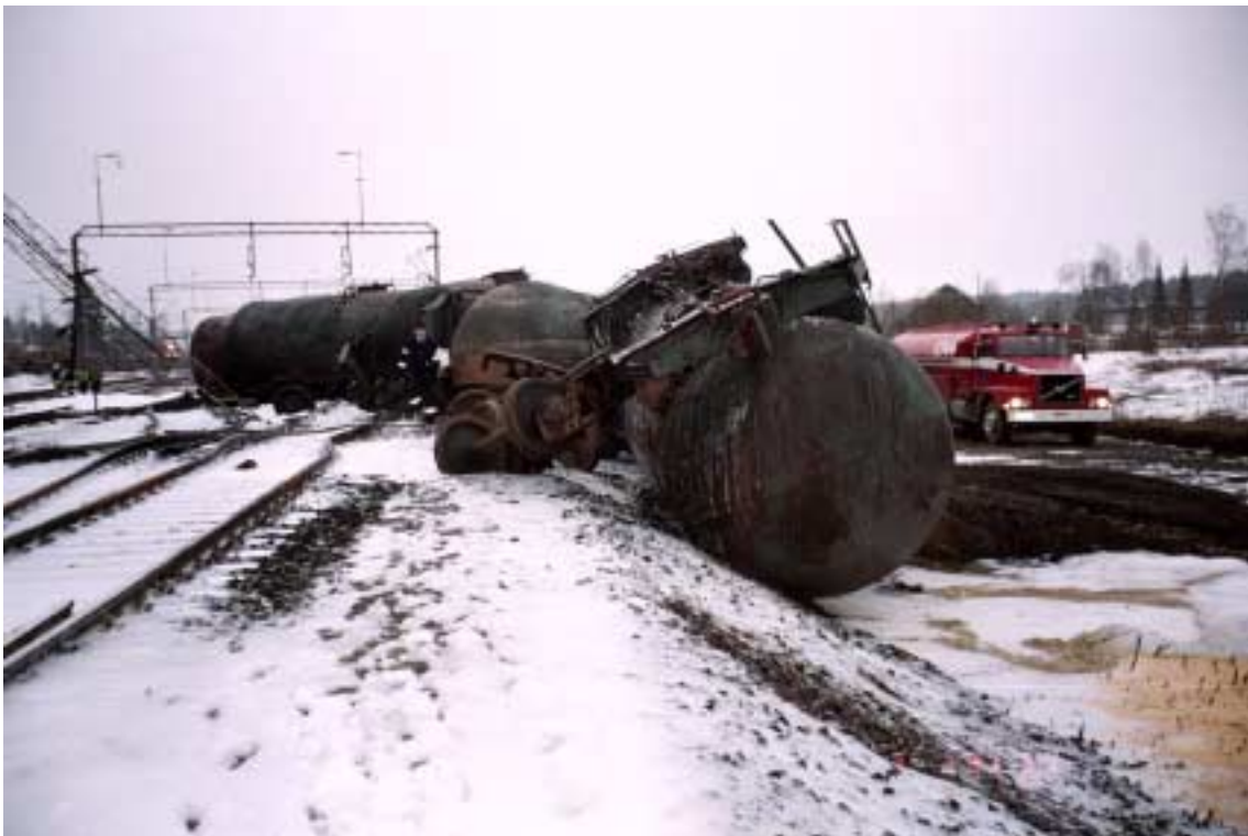
Kuva 8. Säiliövaunujen suistuminen kiskoilta ja palo Vainikkalassa 7.4.1999. 18. vaunu kaatui ratapenkereen sivuun. Telit irtosivat vaunun kaatuessa. Vaunun asennosta johtuen säiliön ja sen sisällä olleen raakaöljyn kuumenemisesta aiheutui säiliön repeämisvaara. Kuva otettu sammutuksen jälkeen; maassa sammutusvaahtoa.
