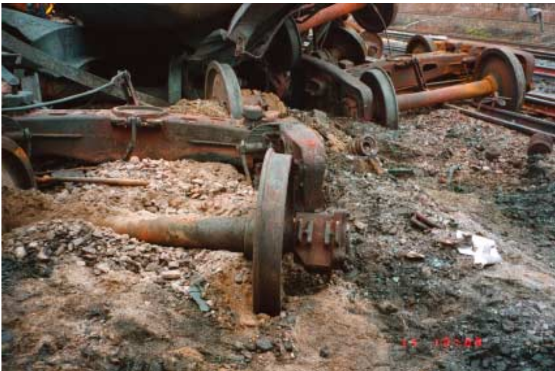
Kuva 12. Säiliövaunujen suistuminen kiskoilta ja palo Vainikkalassa 7.4.1999. Osa vaunujen teleistä painui syväälle sepeliin ja soraan.
