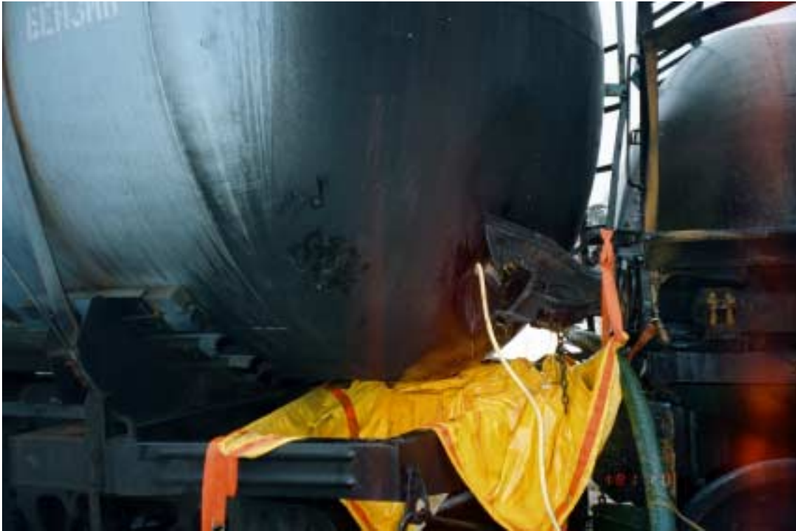
Kuva 11. Säiliövaunujen suistuminen kiskoilta ja palo Vainikkalassa 7.4.1999. 25:nnen vaunun säiliön päädyn reikä tukittiin paineilmatyynyllä ja vuotava raakaöljy ohjattiin astioihin muovipintaisella kankaalla.
