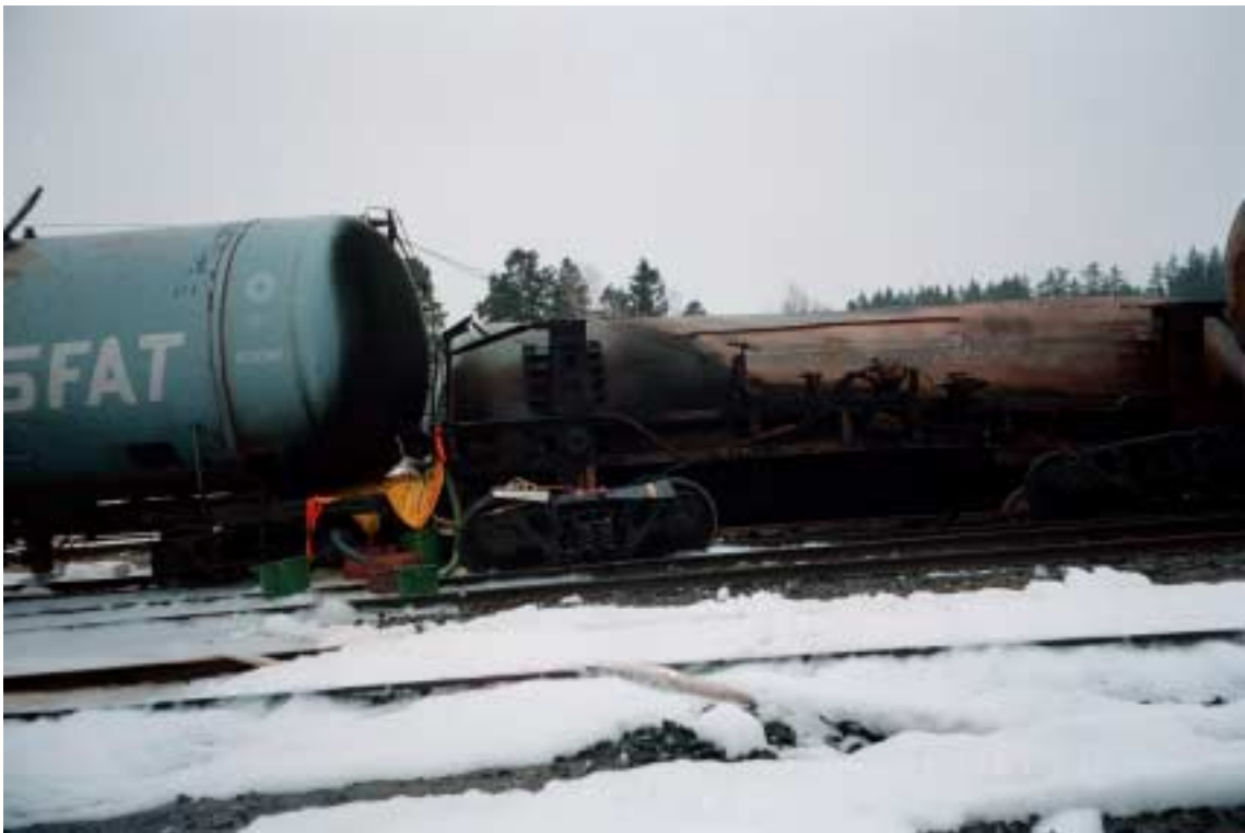
Kuva 10. Säiliövaunujen suistuminen kiskoilta ja palo Vainikkalassa 7.4.1999. 24. vaunu kaatui vasemmalle kyljelleen. 25:nnen vaunun päädyssä ollutta reikää tukittiin paineilmakäyttöisellä nostotyynyllä ja valuva öljy ohjattiin astioihin.
