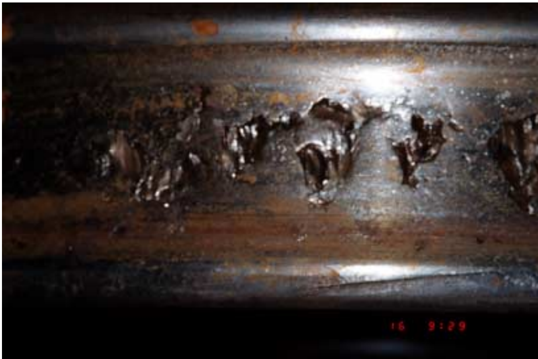
Kuva 3. Henkilöjunan laakerin kuumakäynti Viinijärvellä 5.3.1999. Vaurioituneen pyöräkerän kulkukehällä oli materiaalin väsymisestä johtuvia murentumia. Kulkukehän epätasaisuus aiheutti laakerointiin suuren pystysuuntaisen kuormituksen, jonka seurauksena laakerointi vaurioitui.
