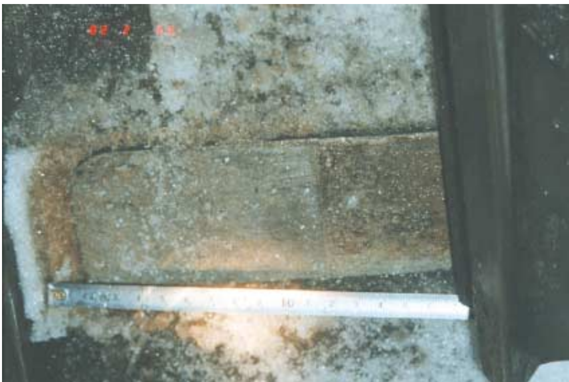
Kuva 3. Säiliövaunujen suistuminen Sköldvikissä 1.3.1999. Vaihte V014 käännettynä johtamaan suoraan raiteelle 2. Tällöin kieli oli noin 17 cm päässä kiskosta.
