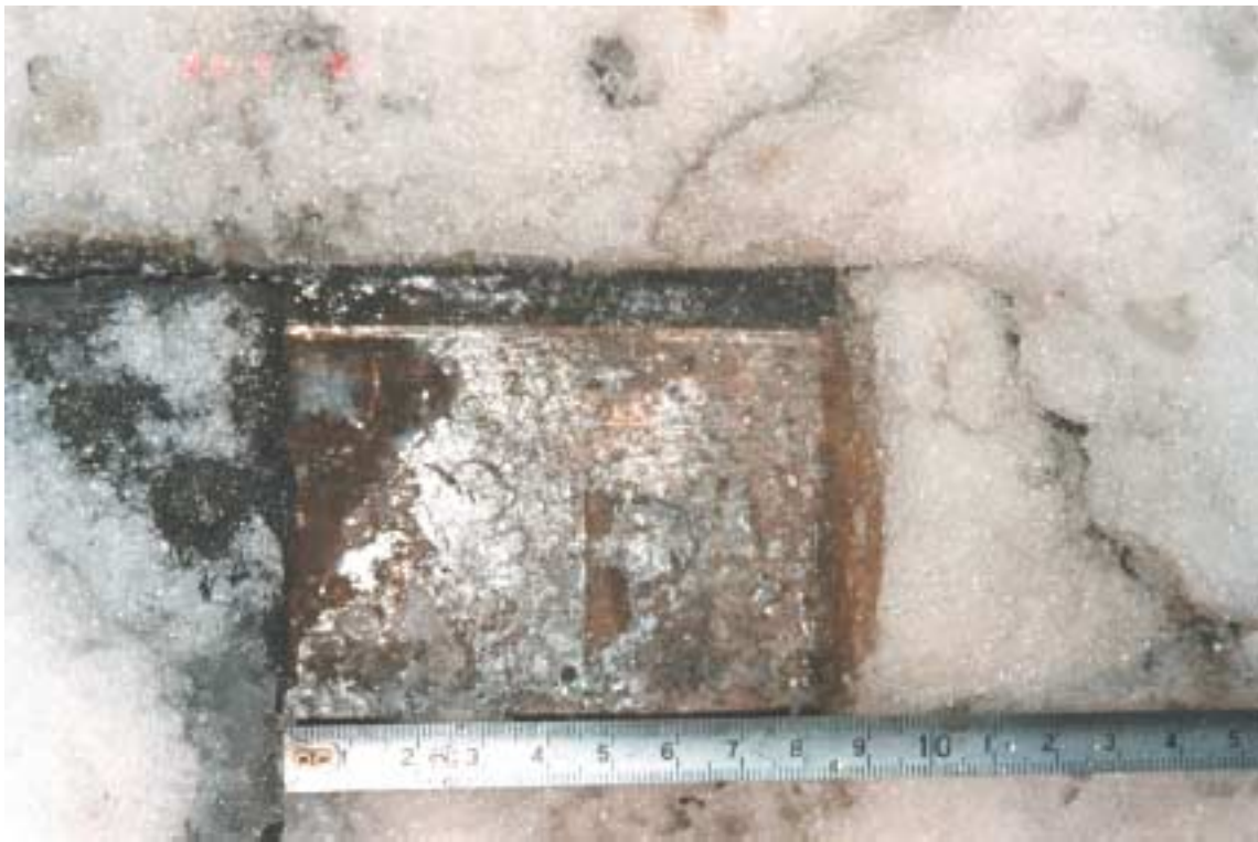
Kuva 2. Säiliövaunujen suistuminen Sköldvikissä 1.3.1999. Vaihteen kielen liukupinnalla olleeseen lumeen jääneistä jäljistä nähdään, että vaihteen kieli oli käynyt enimmillään 8,5 cm päässä kiskosta.
