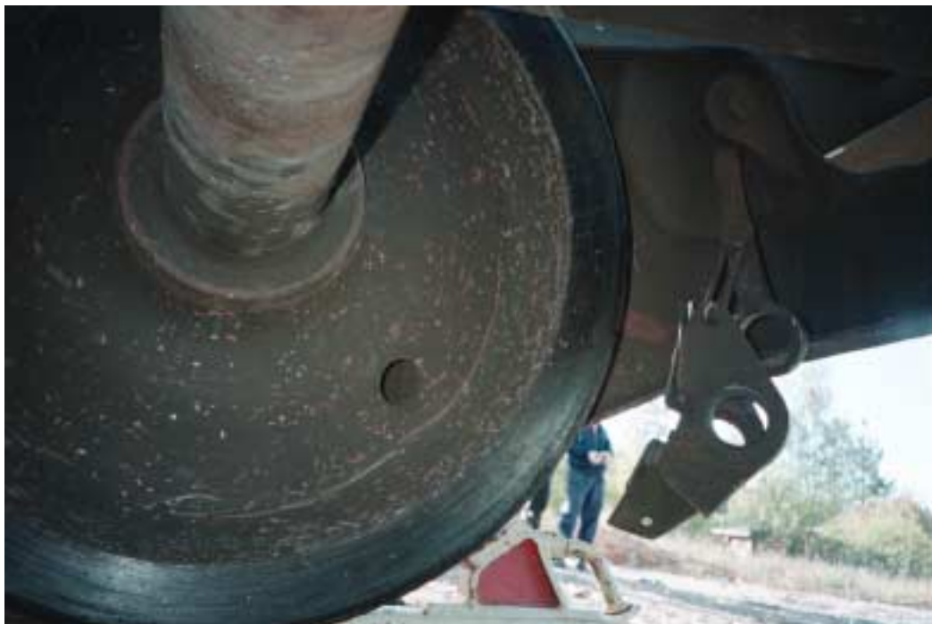
Kuva 5. Säiliövaunun jarrukolmion irtoamisesta aiheutunut vaaratilanne Humppilassa 18.9.1999. Jarrukolmion vasemman pään kannatin oli edelleen paikallaan, mutta jarrukolmio oli irronnut jarrutönkän kengästä. Huomaa kiillottunut pyöränlaipan sisäpinta.
