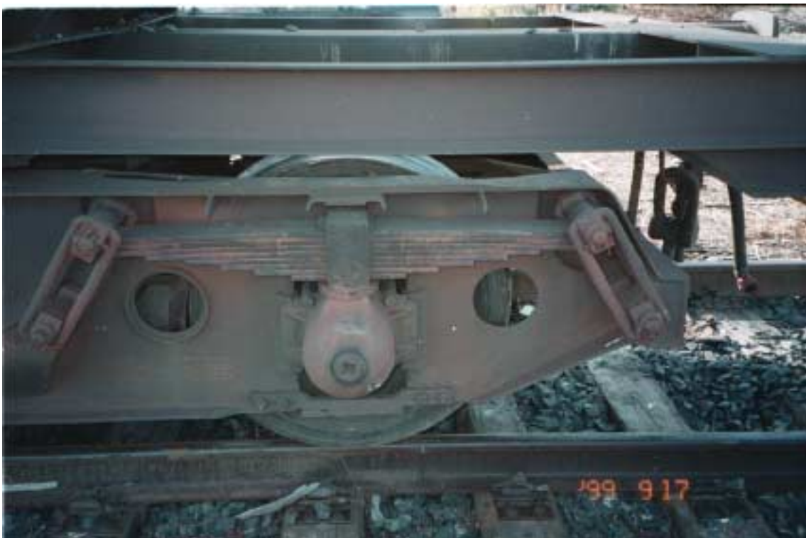
Kuva 3. Säiliövaunun jarrukolmion irtoamisesta aiheutunut vaaratilanne Humppilassa 18.9.1999. Jarrutönkät näkyvät telissä olevista rei'istä; oikeanpuoleisesta tönkkä puuttuu.
