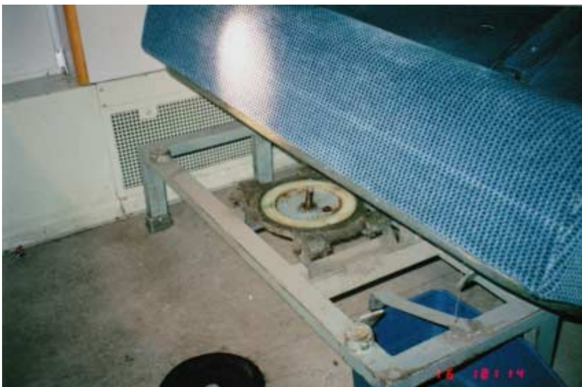
Kuva 8. Tasoristeysonnettomuus Hangossa 16.3.1998. Toisena olleessa vaunussa olleen penkin kääntömekanismin katkennut keskiötappi. Figure 8. Level crossing accident at Hanko on March 16, 1998. Broken king pin of a seat in the second coach.
