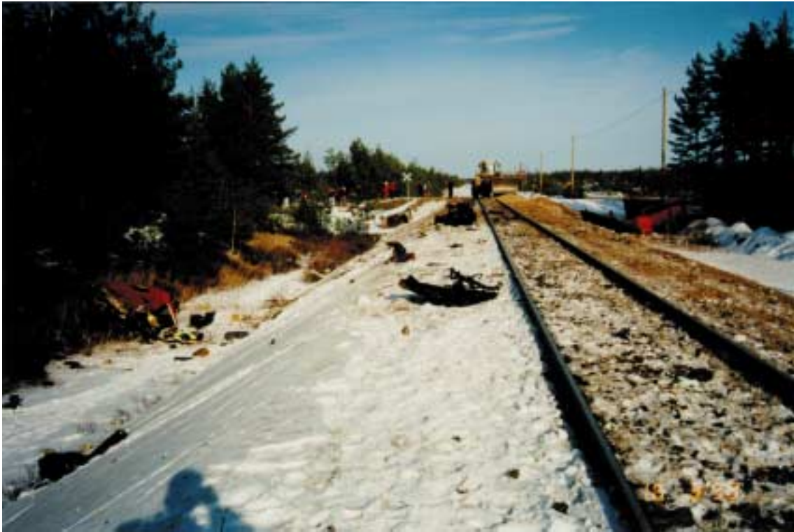
Kuva 5. Tasoristeysonnettomuus Hangossa 16.3.1998. Kuorma-auton osat levinneenä pitkin ratapenkerettä; ohjaamo vasemmalla.
