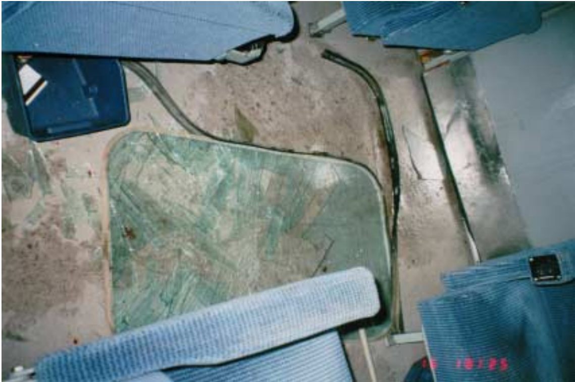
Kuva 9. Tasoristeysonnettomuus Hangossa 16.3.1998. Ensimmäisen vaunun takapään osaston päätyoven irronnut ja rikkoutunut ikkunalasi. Ikkunassa käytetty lasi ei ollut turvalasia.
