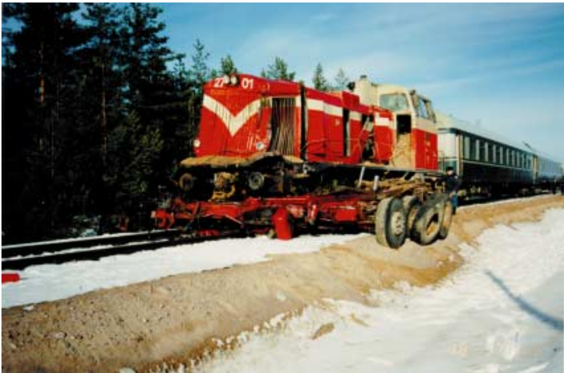
Kuva 6. Tasoristeysonnettomuus Hangossa 16.3.1998. Kuorma-auton runko taittuneena veturin keulassa. Hiekkaa mennyt veturin ohjaamon sisälle.
