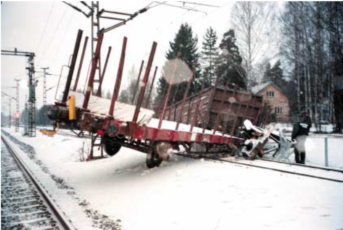
Kuva 2. Itsestään liikkeelle lähteneiden tavaravaunujen aiheuttama vaaratilanne Saunakalliossa 25.2.1998. Ensimmäisenä kulkenut vaunu murskasi raidepuskimen ja kääntyi poikittain itäisen pääraiteen avoimen tilan ulottumaan saakka.
