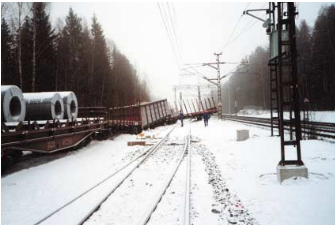
Kuva 3. Itsestään liikkeelle lähteneiden tavaravaunujen aiheuttama vaaratilanne Saunakalliossa 25.2.1998. Suistumiskohta vaunujen tulosuunnasta katsottuna.
