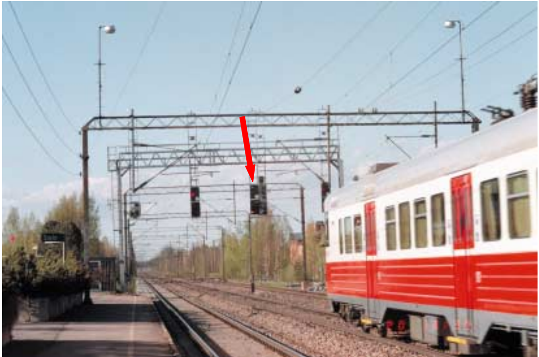
Kuva 4. Savion lähtösuunnan pääopastin P 512 ("aja"-opaste) ja sen alapuolella Keravan tulosuunnan pääopastimen esiopastin, jossa "odota sn 35"-opaste.
