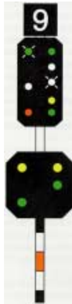
Kuva 2. Itävallan opastinjärjestelmän opastimien yhdistelmä, jossa pääopastimen yläpuolella numero-opastin ja alapuolella esiopastin. Opastimessa näkyy kaikki mahdolliset valot.
