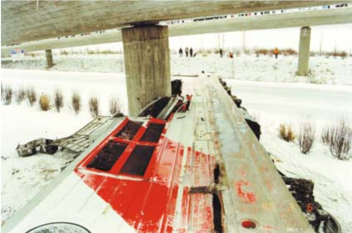
Kuva 6. Jyväskylän junaonnettomuus 6.3.1998. Veturi romuttui täysin osuttuaan katto edellä siltapilariin. Veturin oikeassa kyljessä näkyvät luisumisjäljet. Kovasta törmäyksestä huolimatta siltapilari ja silta eivät vaurioituneet. Toinen veturinkuljettaja putosi kaatuneen veturin sivuikkunasta jääden veturin alle.
