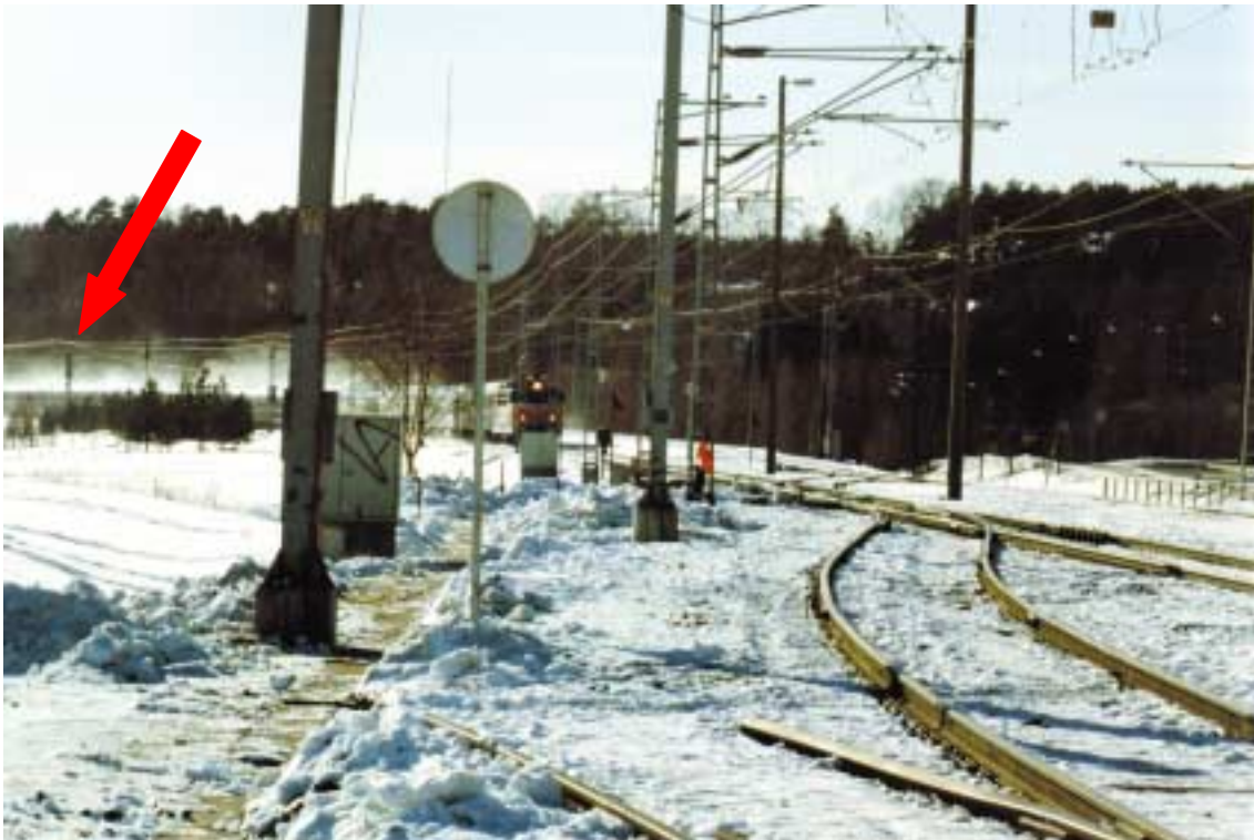
Kuva 1. Jyväskylän junaonnettomuus 6.3.1998. Rekonstruktioajossa onnettomuusjunaa simuloitunut juna on ohittanut pääopastimen (nuoli) ja lähestyy kulkusuunnassaan oikealle kääntyvää vaihdetta nopeudella 127 km/h. Suurin sallittu nopeus vaihteessa olisi ollut 35 km/h.
