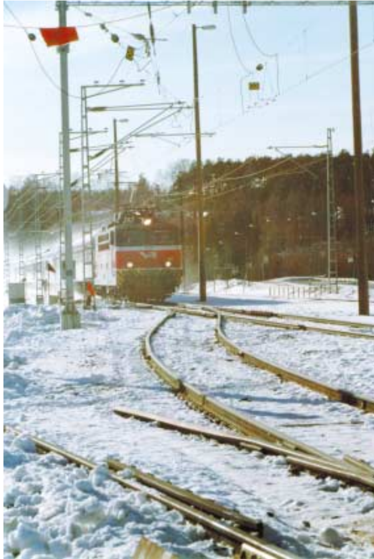
Kuva 2. Jyväskylän junaonnettomuus 6.3.1998. Onnettomuusjuna simuloi juna saapuu nopeudella 110 km/h vaihteeseen, jossa suurin sallittu nopeus olisi ollut 35 km/h. Yhtätoista vaunua vetänyt veturi kallistui ensin vasemmalle ja kaatui sen jälkeen oikealle kyljelleen liukuen noin 200 metriä. Veturi veti perässään kiskoilta kaksi ensimmäistä matkustajavaunua.
