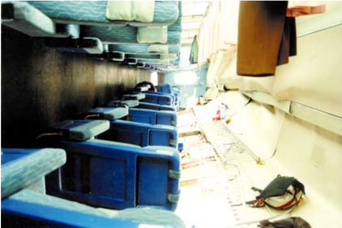
Kuva 12. Jyväskylän junaonnettomuus 6.3.1998. Onnettomuuden rajuudesta huolimatta kaatuneet teräsvaunut säilyttivät hyvin muotonsa. Kuvan vaunu oli peruskorjattu kuukautta ennen onnettomuutta, jolloin myös penkkien kiinnitystä oli parannettu. Kaikki penkit pysyivät vaunun muodonmuutoksista huolimatta kiinnityksissään.
