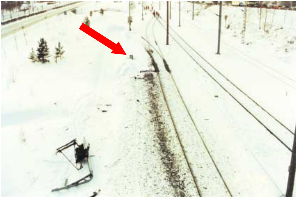
Kuva 3. Jyväskylän junaonnettomuus 6.3.1998. Kaatuessaan veturi katkaisi ajojohdinten kannatinpylvään (nuoli). Veturin toinen virroitin jäi kaatumispaikalle.
