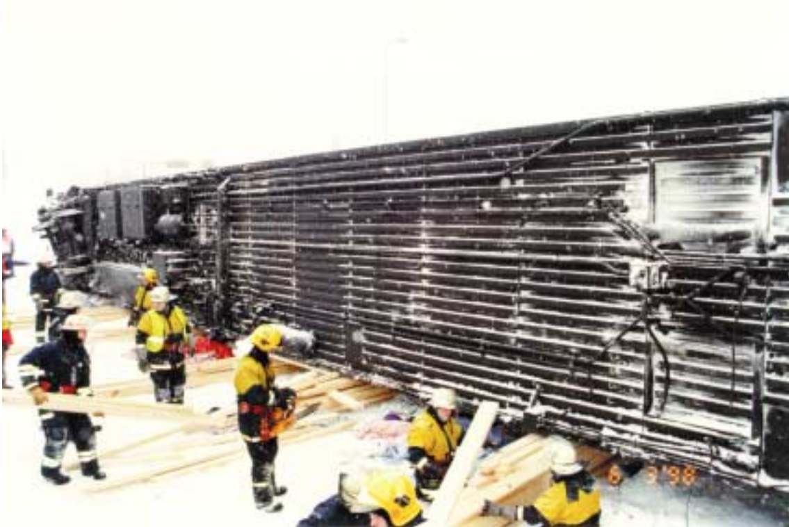
Kuva 11. Jyväskylän junaonnettomuus 6.3.1998. Vaunun alle puristuksiin jääneet matkustajat saatiin irrotettua kohottamalla vaunua palokuntien nostokalustolla. Onnettomuudessa menehtyneet saatiin vaunujen alta nostamalla vaunut autonosturilla ilmaan ja tukemalla vaunujen alle puutavaraa.
