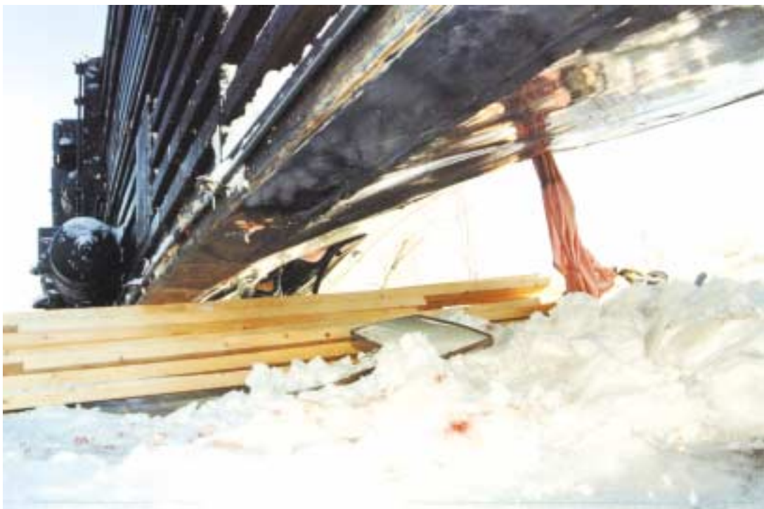
Kuva 9. Jyväskylän junaonnettomuus 6.3.1998. Junassa toisena ollut päivävaunu kaatui kyljelleen lumivallin päälle, jolloin vaunuun tuli painauma. Vaunu liukui vielä muutamametrin ja syntynyt painauma mahdollisti ihmisten ulospääsyn nuolen osoittamasta paikasta. Lisäksi matkustajat tulivat ulos vaunun päädyistä. Muutama matkustaja tuli yläpuolella olevien ikkunoiden kautta ulos. Tässä vaunussa olleista ainakin 45 matkustajasta menehtyi seitsemän henkilöä. Alimmaisen lähikuva painaumasta.
