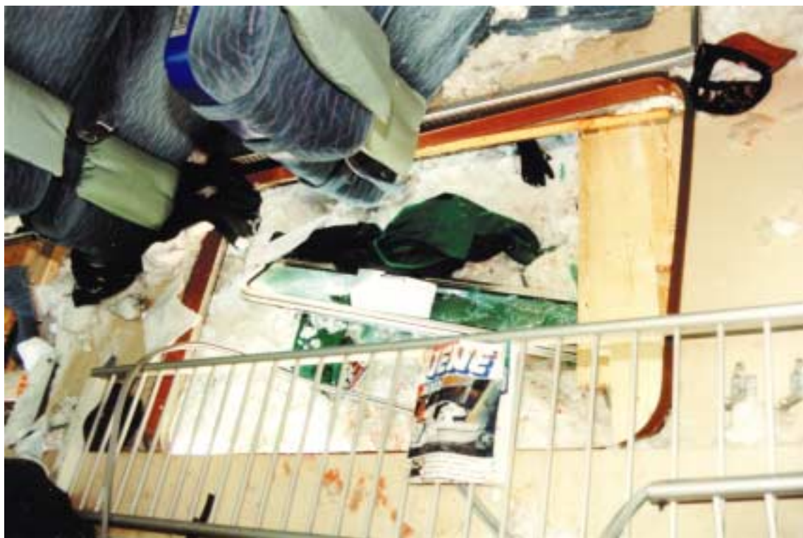
Kuva 10. Jyväskylän junaonnettomuus 6.3.1998. Toisessa vaunussa matkustajat menehtyivät pudottuaan ulos rikkoutuneista ikkunoista ja jäätyään osittain tai kokonaan vaunun alle. Ikkuna-aukkojen päälle irronneet matkatavarahyllyt estivät joidenkin matkustajien putoamisen vaunusta.
