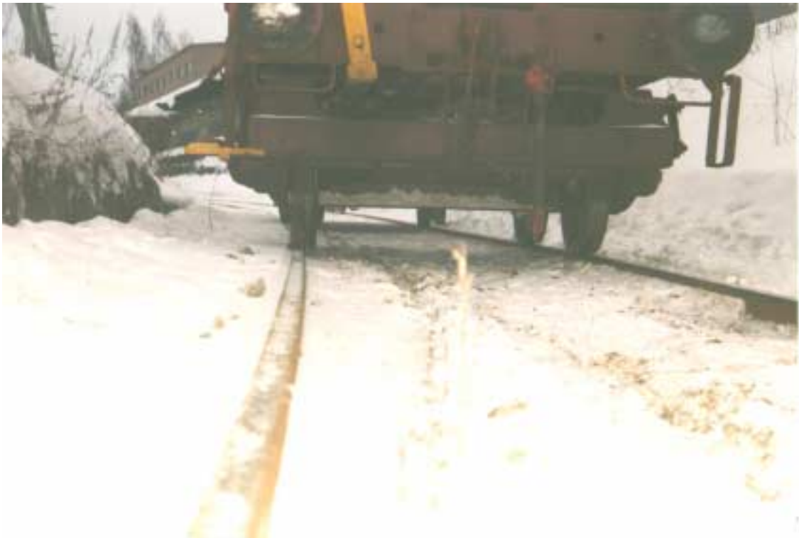
Kuva 12. C6/1997 R 16.2 ja 19.2.97 Kuusankoski UPM- Kymmene Oy:n tehtaat. Kallioleikkauksessa suistuva kloorivaunu olisi vioittuessaan vaarallinen ihmisille ja ympäristölle.
