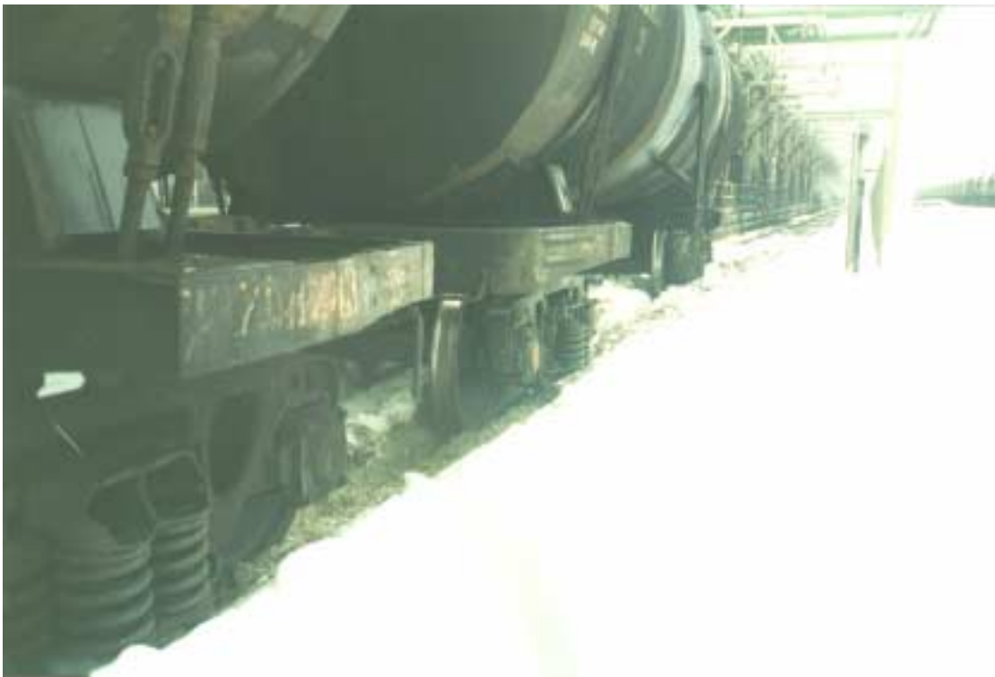
Kuva 14. C8/1997 R 23.2.97 Hamina ratapiha Neste Oy:n raiteisto. Tyhjät kemikaalivaunut suistuivat vasemmalle juuri ennen tuloaan lastaus- ja purkausalueelle.
