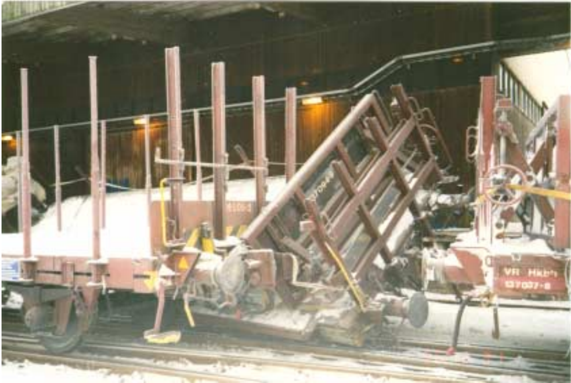
Kuva 9. C24/1996 R 31.12.96 Uusikaupunki Kemira Agro Oy:n tehtaat. Lannoitelastissa olleen junan tyhjä välivaunu suistui vaihteessa kiskoilta, koska vaihde ei ollut kunnossa. Samalla suistui myös neljä muuta vaunua.
