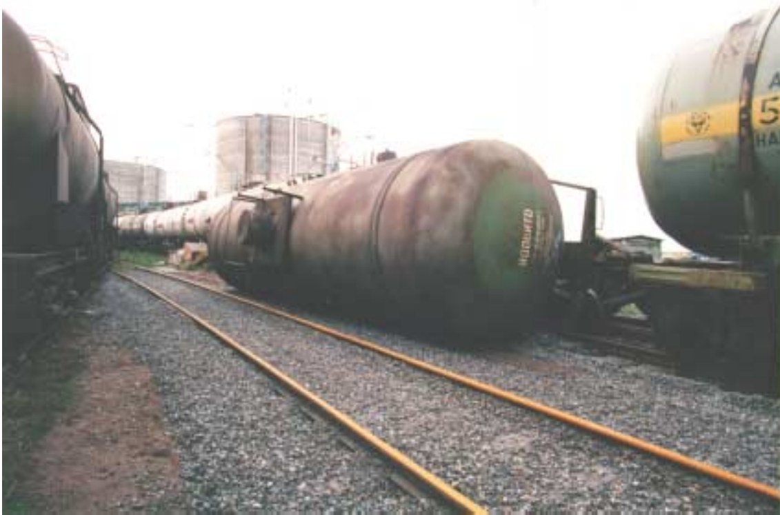
Kuva 7. C21/1996 R 17.11.96 Uusikaupunki Kemira Agro Oy:n tehtaat. Tyhjä ammoniakkivaunu suistui kiskoilta vaihteessa vaihteen oltua väärässä asennossa. Vaunu kaatui, mutta ei säiliö ei rikkoutunut.
