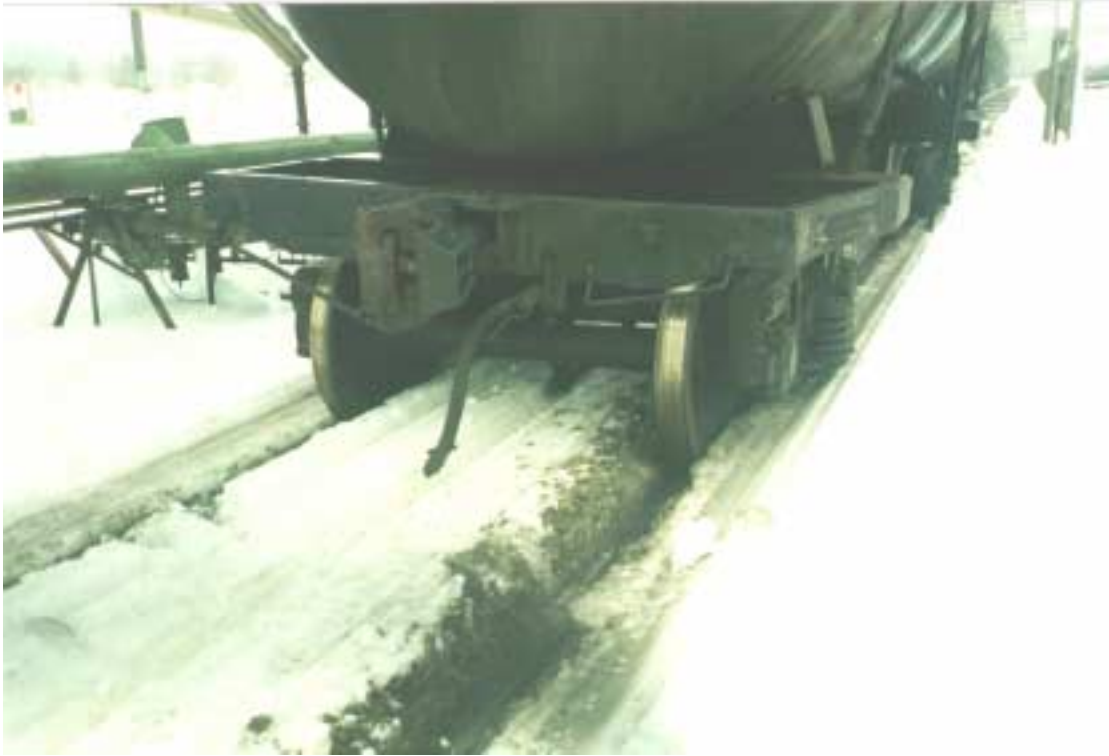
Kuva 13. C8/1997 R 23.2.97 Haminan ratapiha Neste Oy:n raiteisto. Tyhjiä kemikaalivaunuja työnnettiin lumisella puhdistamattomalla kiskotuksella kohti lastauspaikkaa. Taustalla olevalta lastaus- ja purkausalueelta lumi on sulanut putkistojen lämmön vaikutuksesta.
