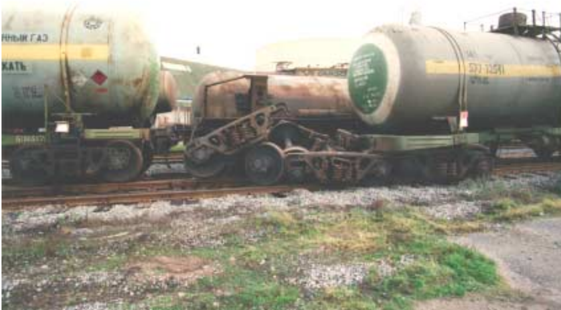
Kuva 8. C21/1996 R 17.11.96 Uusikaupunki Kemira Agro Oy:n tehtaat. Suistuneen ja kaatuneen ammoniakkivaunun telit kasautuivat seuraavan vaunun eteen. Myös tämän vaunun etuteli suistui kiskoilta. Junan nopeus oli pieni, koska se oli juuri lähtenyt vetämään suistuneita vaunuja.
