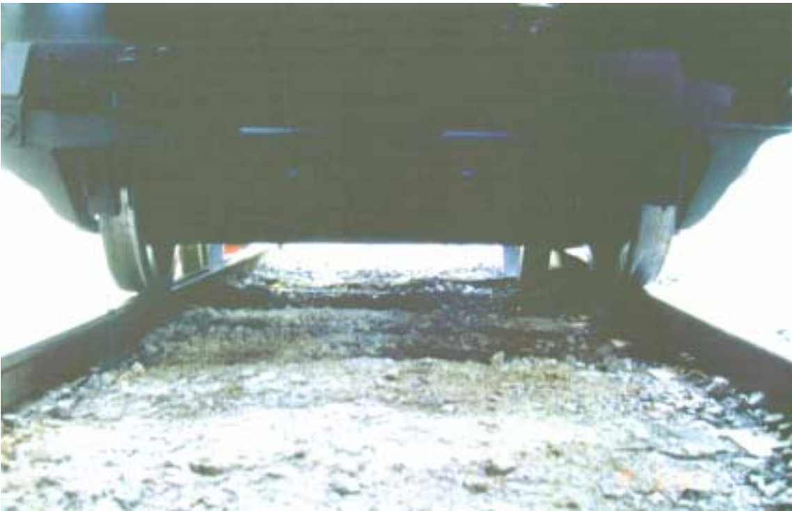
Kuva 18. C15/1997 R Kuusankoski UPM- Kymmene Oy:n tehtaat. Juna pysähtyi juuri kun myös muut pyörästöt olivat suistumassa kiskoilta.
