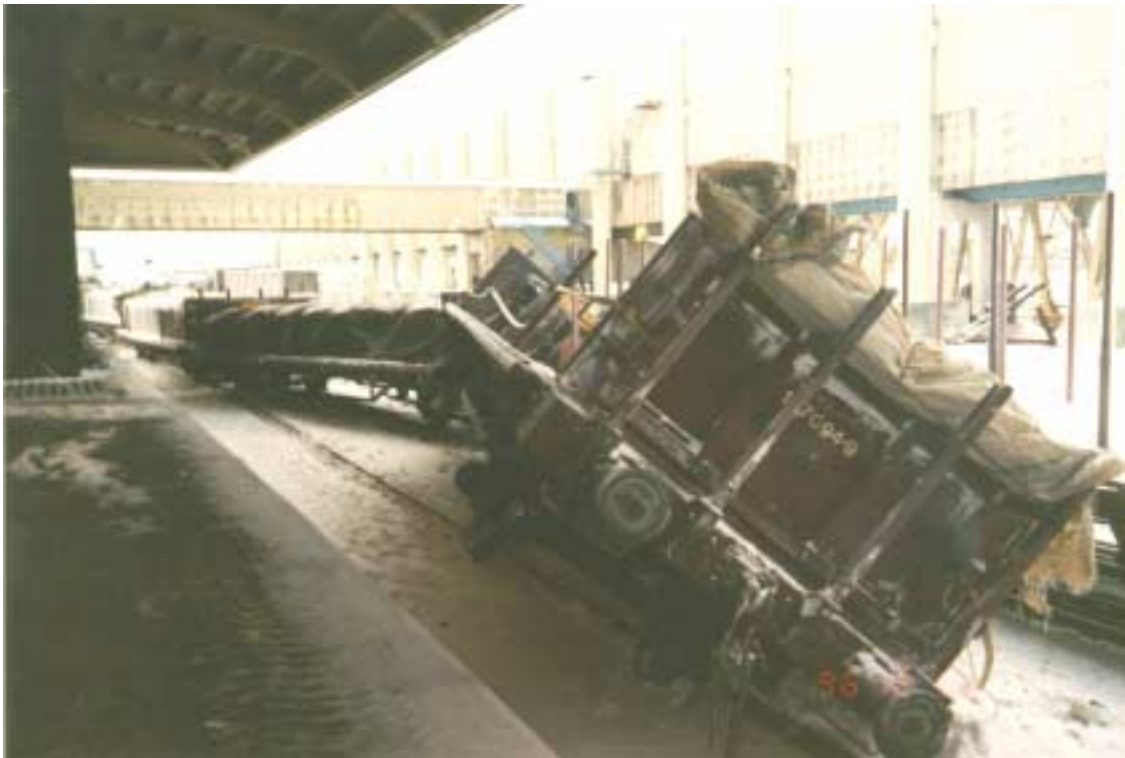
Kuva 10. C24/1996 R 31.12.96 Uusikaupunki Kemira Agro Oy:n tehtaat. Vaihteessa väärille kiskoille lähtenyt vaunu kaatui ja jäi seuraavien myös suistuneiden vaunujen väliin. Vaunut kärsivät pienehköjä vahinkoja.
