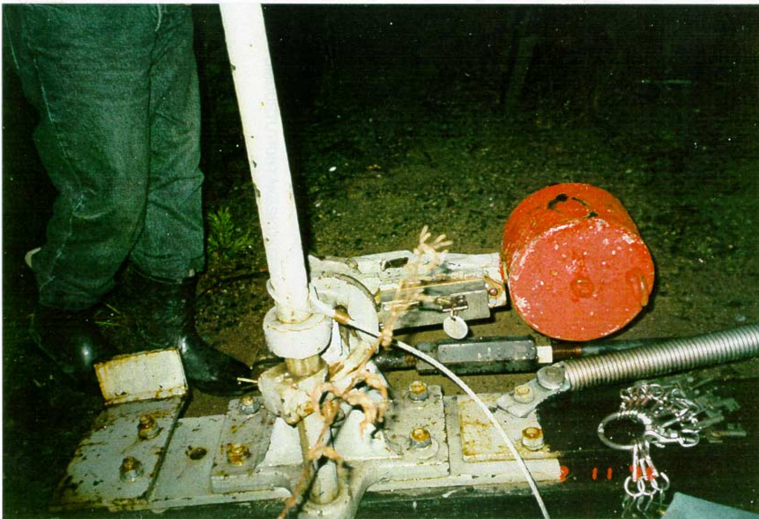
Kuva 11. Kaksoisraiteensulkija SpI lukittuna kiskoille käännettyyn asentoon. Huomaa vaihteen 1 varmistuslukkoon tarvittava avain paikallaan.
