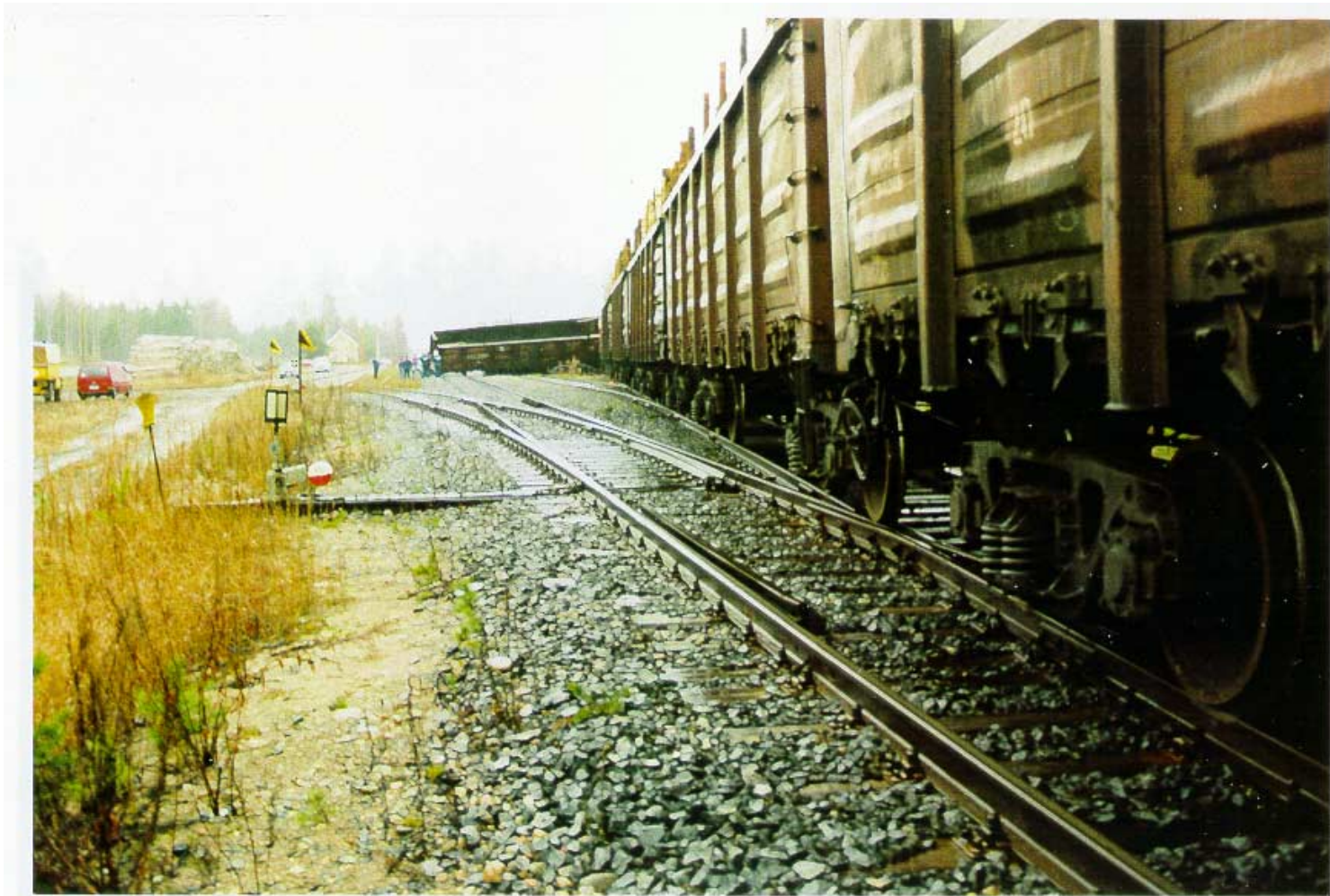
Kuva 2. Yleiskuva onnettomuuspaikasta junan tulosuunnasta katsottuna. Etuvasemmalla näkyy vaihteen 11 vaihteenkääntäjä. Suistuneen vaunun pää on pääraiteen päällä. Takavasemmalla näkyy keltainen toimistorakennus.
