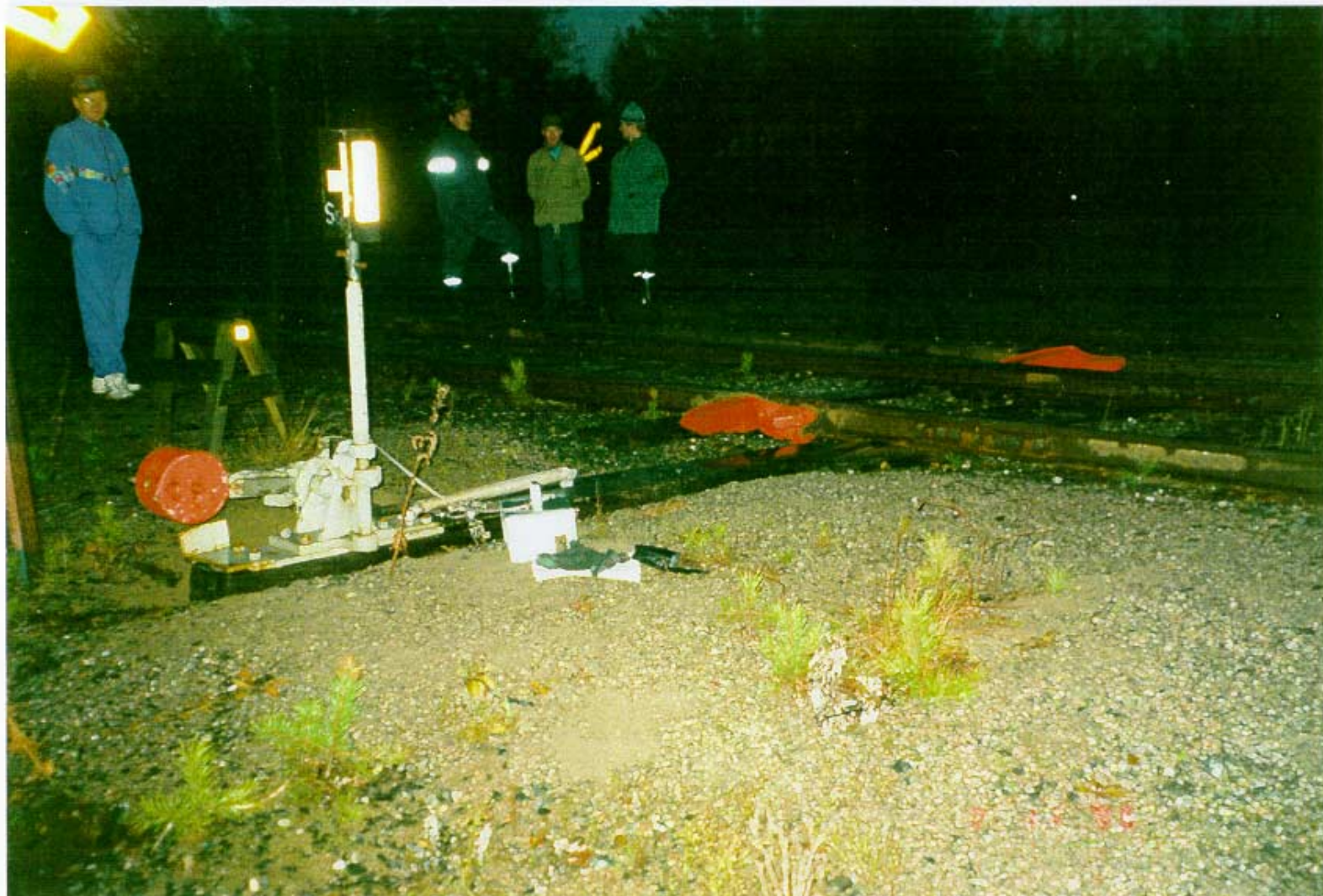
Kuva 7. Kaksoisraiteensulkija SpI auki asennossa.
