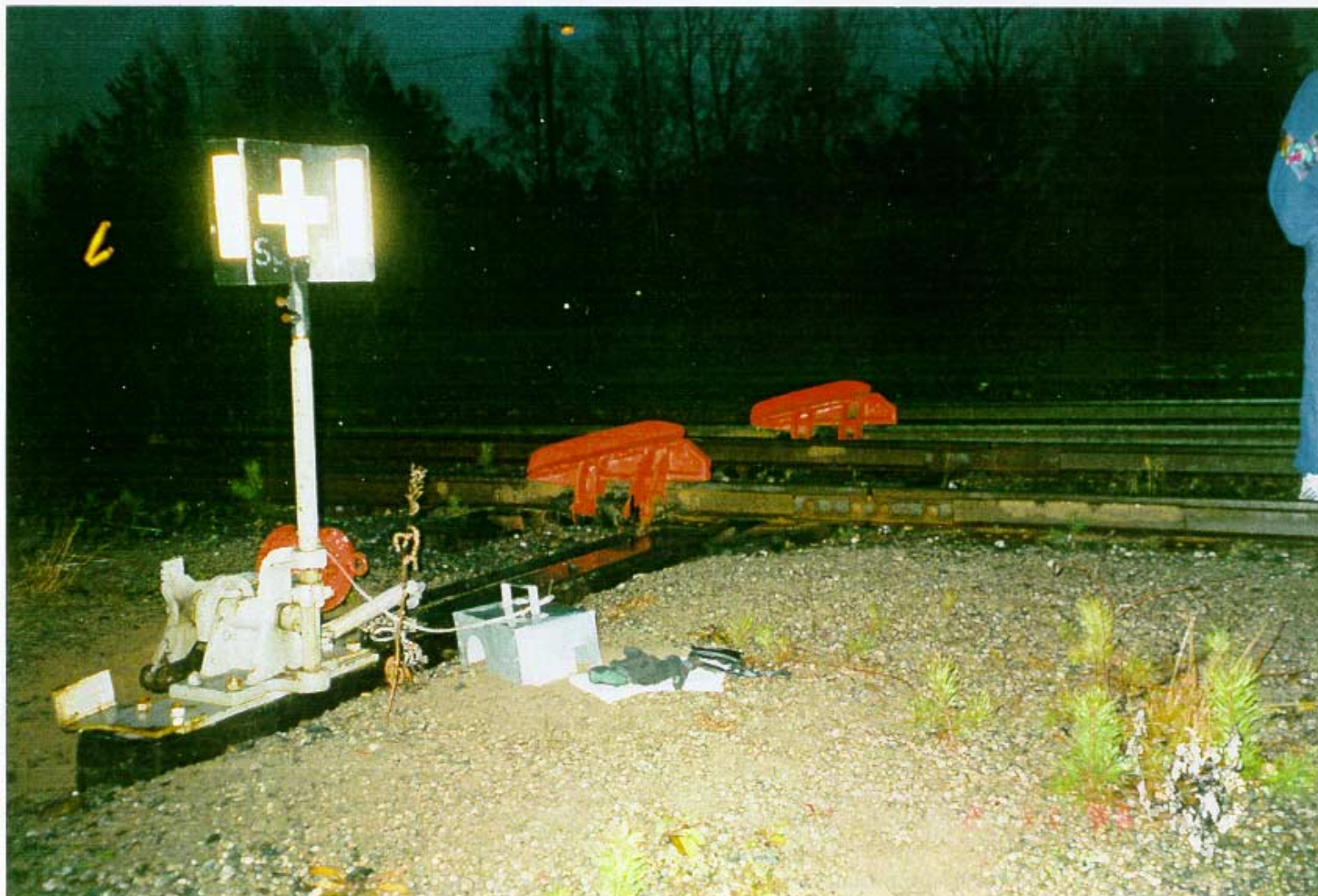
Kuva 8. Kaksoisraiteensulkija SpI kiskoille käännettyssä asennossa.
