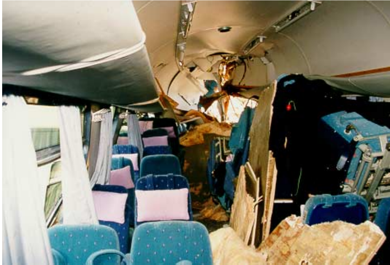
Kuva 15. Toisena ollut päivävaunu säilyi veturin osumiskohtaa lukuunottamatta yllättävän ehjänä.
