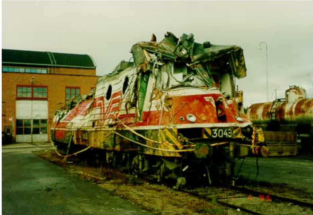
Kuva 6. Veturi murskaantui onnettomuudessa pahoin. Ajo-ohjaamon muodonmuutokset olivat niin suuria, että veturinkuljettaja ja ohjaamossa ollut matkustaja puristuivat kuoliaiksi.
