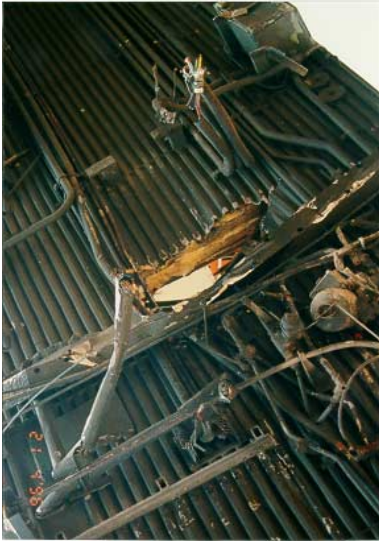
Kuva 26. Matkustajavaunujen pohjarakenne vaikuttaa heikommalta kuin vaunun muut rakenteet. Vaunun pohjaan on kiinnitetty laitteita, jotka voivat repiä vaunun pohjaan suuria reikiä vaunun suistuessa kiskoilta.
