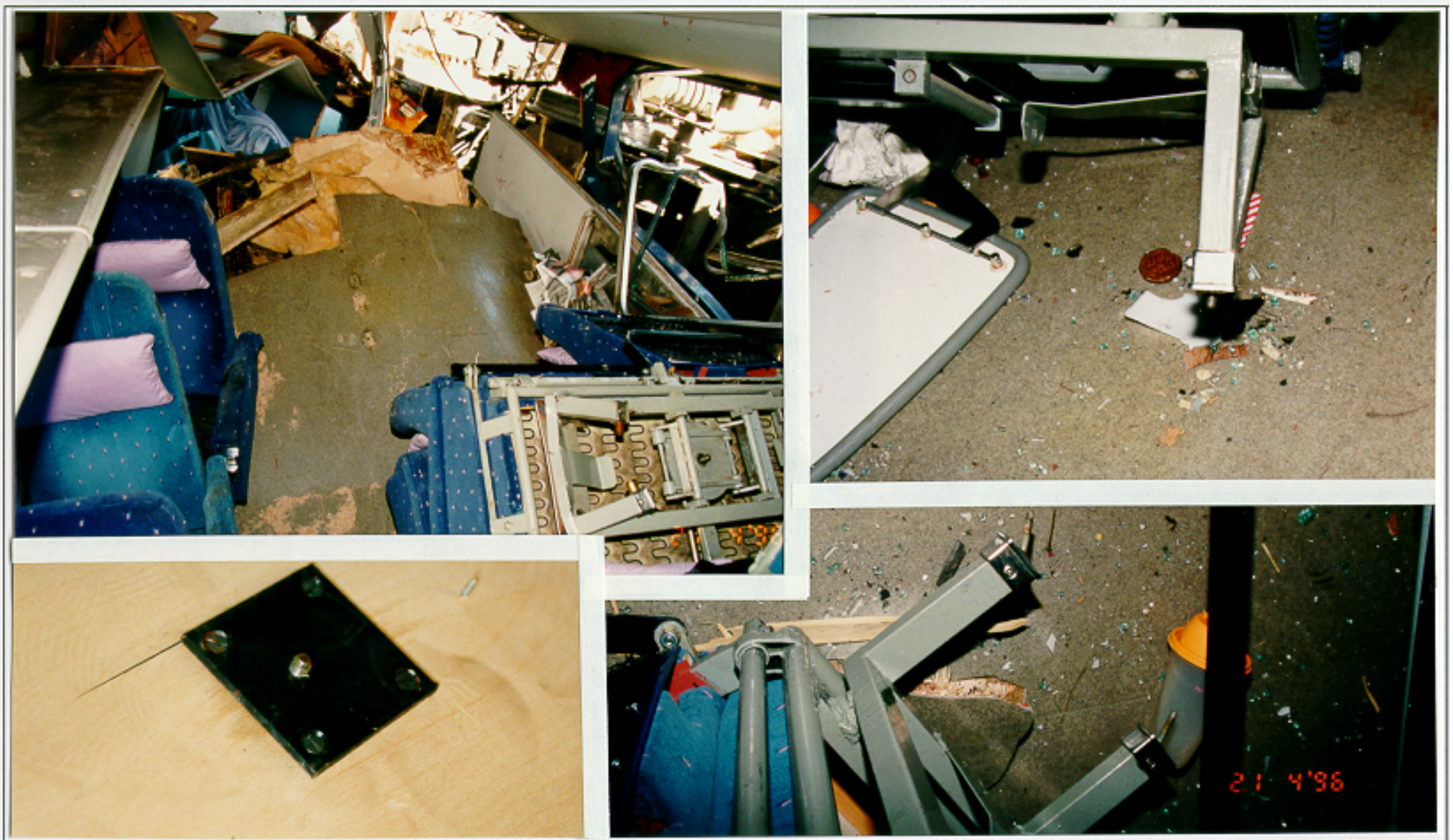
Kuva 25. Penkit irtosivat päivävaunuissa joko kiinnitysalkojen murtumisen tai puutteellisen kiinnityksen vuoksi.
