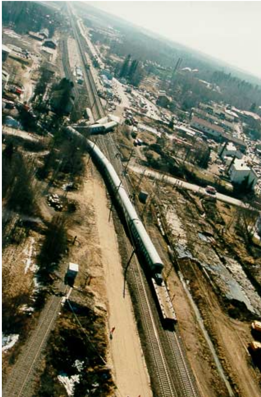
Kuva 3. Junan massa ja nopeus aiheuttivat sen, että osa vaunuista törmäsi paikalleen kaatuneeseen veturiin. Veturin kuljettaja ja veturissa ollut matkustaja saivat välittömästi surmansa.
