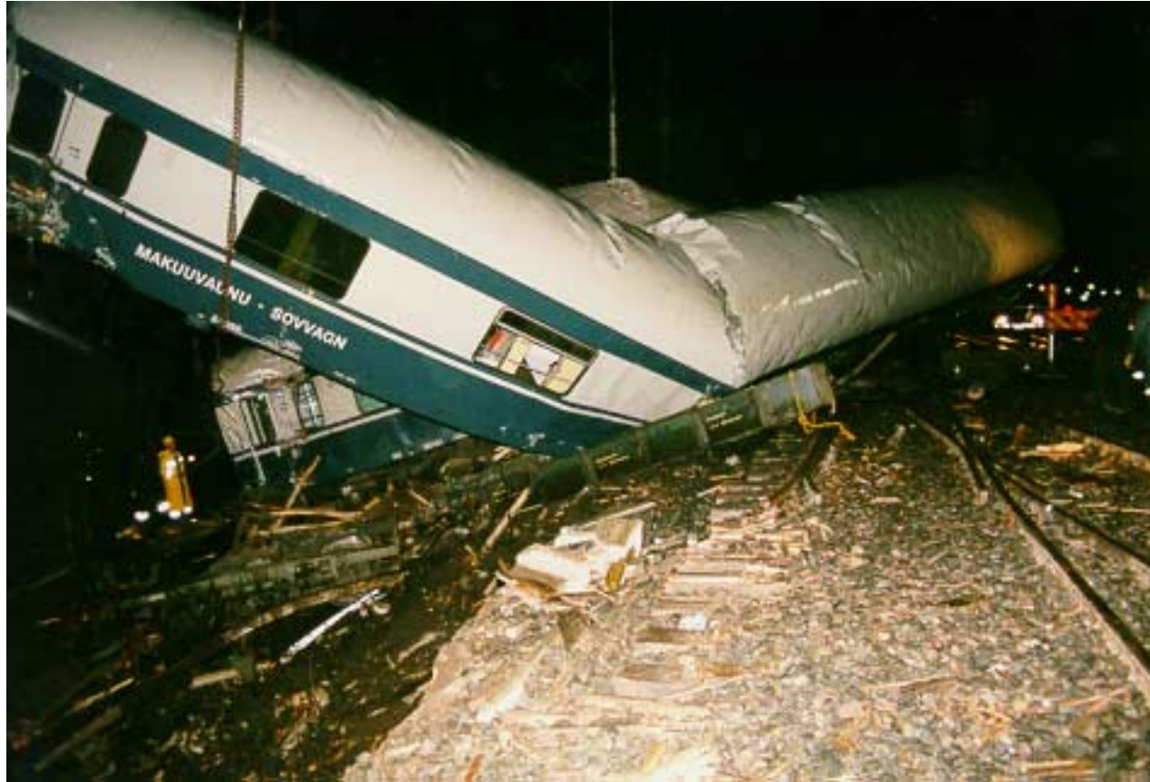
Kuva 21. Raivauksessa vaurioituneet vaunut nostettiin alas ratapenkereeltä. Osa vaunuista katkaistiin kuljettamisen helpottamiseksi. Viidentenä ollut vaunu taittui raivausvaiheessa kahtia.
