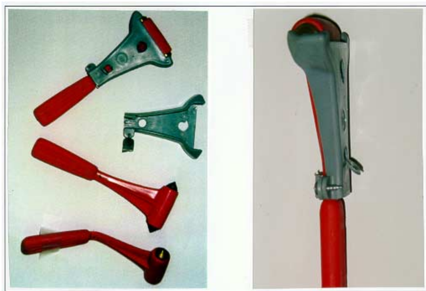
Kuva 28. Ikkunanrikkomisvasarat sopivat hyvin tarkoitukseensa. Vasaroita kuitenkin puuttuu paljon vaunuista. Vasaroiden kiinnitys on myös liian tiukka, jolloin irrottaminen on usein mahdotonta. Usein vasaran mukana lähtee myös muoviteline, jolloin vasarasta tulee käyttökelvoton.
