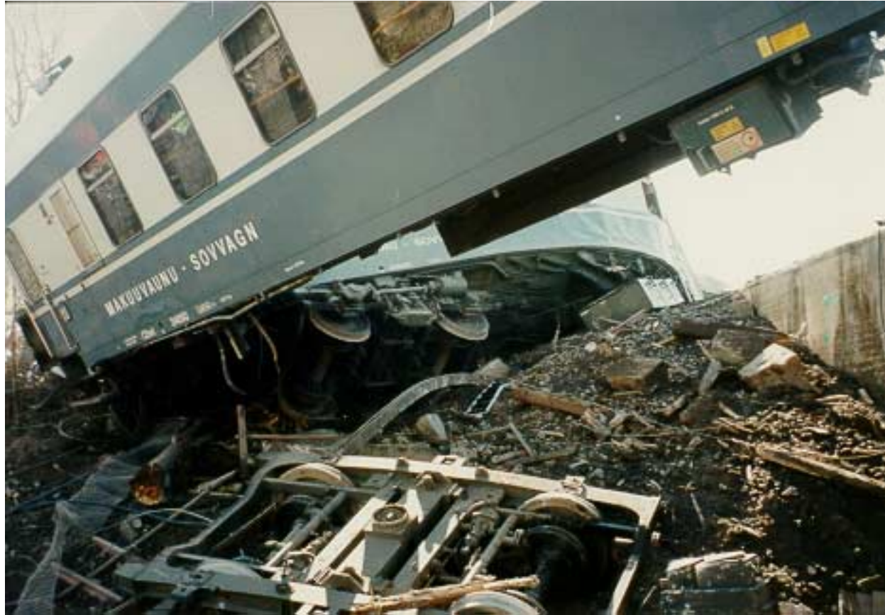
Kuva 19. Kuudentena ollut makuuvaunu jäi roikkumaan "tyhjän päälle". Telit repeytyivät irti ja makuuhyttien lattioihin tuli suuria reikiä.
