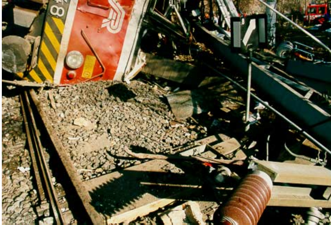
Kuva 20. Usein näin rajussa onnettomuudessa virtajohdot katkeavat ja muuttuvat jännitteettömiksi. Sähkön aiheuttama vaara matkustajille on suurin onnettomuuksissa, joissa johtimet jäävät jännitteellisiksi. Onnettomuuden tapahduttua on vaikea estää matkustajien poistumista vaunuista ennen kuin hätämaadoitus on tehty.
