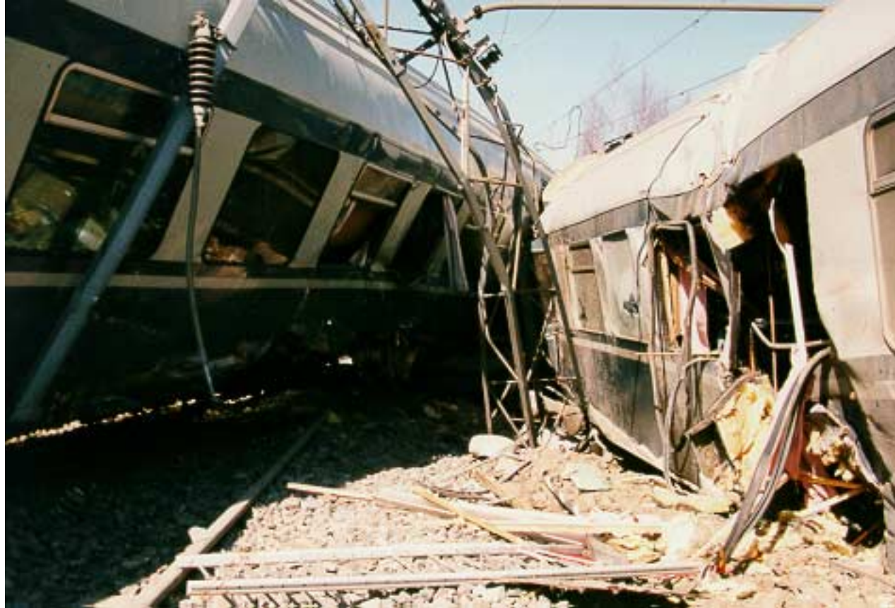
Kuva 13. Ensimmäisenä olleesta päivävaunusta (oik.) lähtivät molemmat telit irti ja molempiin kylkiin tuli törmäysvaurioita. Tulosuuntaansa kääntynyt veturi osui kulkusuunnassa vasempaan sivuun ja kuvassa näkyvään oikeaan sivuun osui ravintolavaunu tai radan rakenteet. Kyseistä osumiskohtaa pelastajat käyttivät kulkuaukkona, josta loukkaantuneet saatiin ulos vaunusta.
