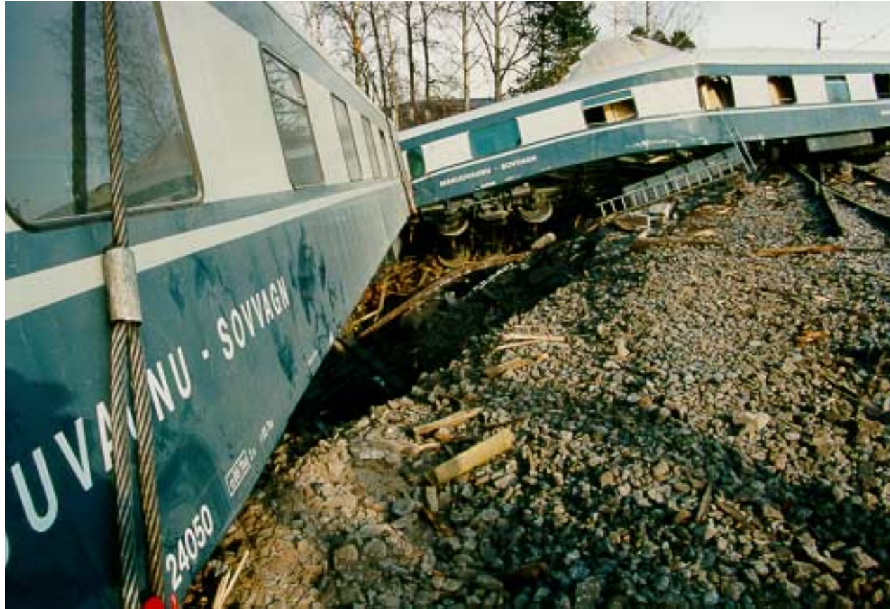
Kuva 18. Taustalla näkyvän viidennen makuuvaunun ainoaksi mahdolliseksi poistumistieksi jäivät oikean puolen käytävän ikkunat, koska vasen puoli oli kiinni päivävaunussa. Ikkunoiden kautta poistumista vaikeutti se, että vaunu oli voimakkaasti kallellaan.
