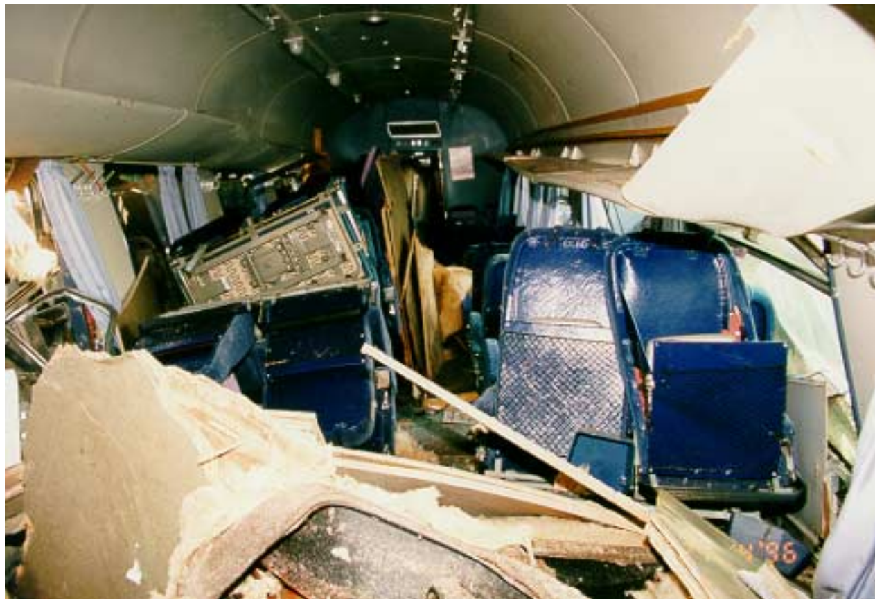
Kuva 16. Vaunun lattia repeytyi useasta kohdasta, jolloin penkit irtosivat.
