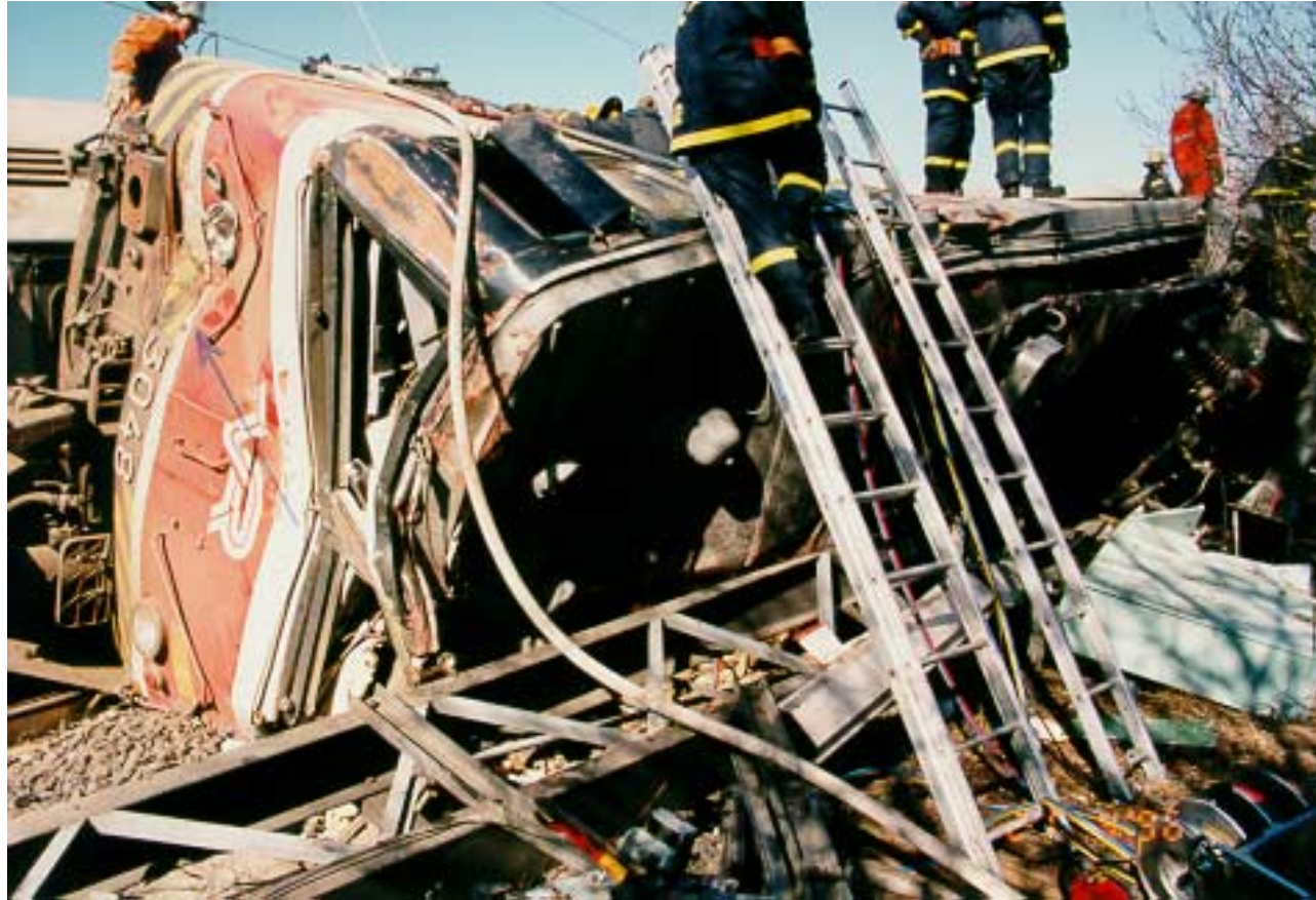
Kuva 5. Kuljettajaa etsittiin aluksi veturin väärästä päästä. Molemmissa päissä on samanlainen ohjaamo ja veturi oli kääntynyt kokonaan tulosuuntaansa. Veturin takaosassa näkyy ensimmäisen päivävaunun puskimesta syntynyt painautuma (nuoli).
