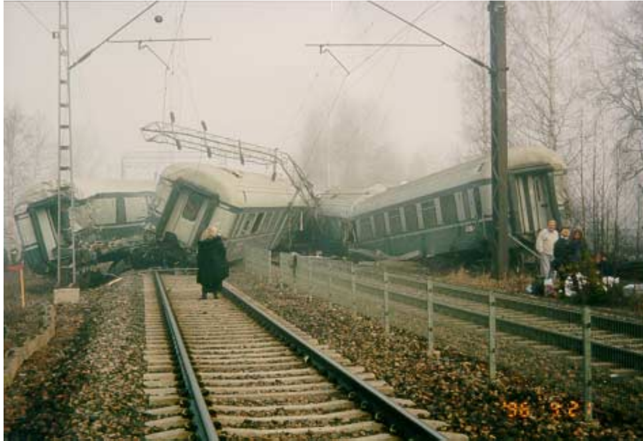
Kuva 7. Puolitoista tuntia onnettomuuden jälkeen paikalla oli vielä jonkin verran sumua. Kuvassa oikealla ensimmäisenä ollut päivävaunu, joka rikkoutui keskiosan molemmilta puolilta. Keskellä ravintolavaunu ja vasemmalla konduktöörivaunu.
