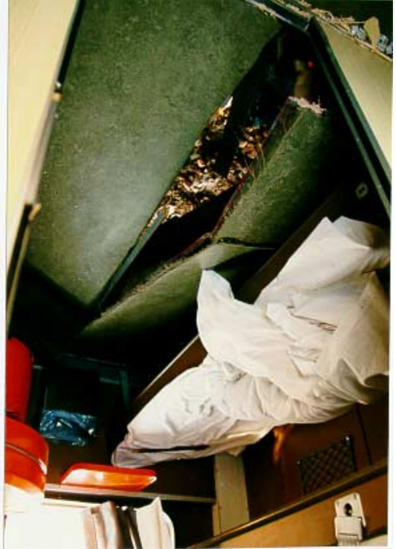
Kuva 26. Matkustajavaunujen pohjarakenne vaikuttaa heikommalta kuin vaunun muut rakenteet. Vaunun pohjaan on kiinnitetty laitteita, jotka voivat repiä vaunun pohjaan suuria reikiä vaunun suistuessa kiskoilta.
