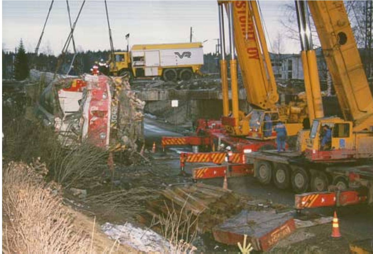
Kuva 22. Viimeisenä siirretyn veturin nostamiseksi tarvittiin kaksi järeeä autonosturia. Vaikka raivauspaikalle oli melko helppo tuoda nostokalustoa, aiheuttivat pitkät nostoetäisyydet sen, ettei yhdellä 200 tonnin nosturilla voinut nostaa 86 tonnin veturia.
