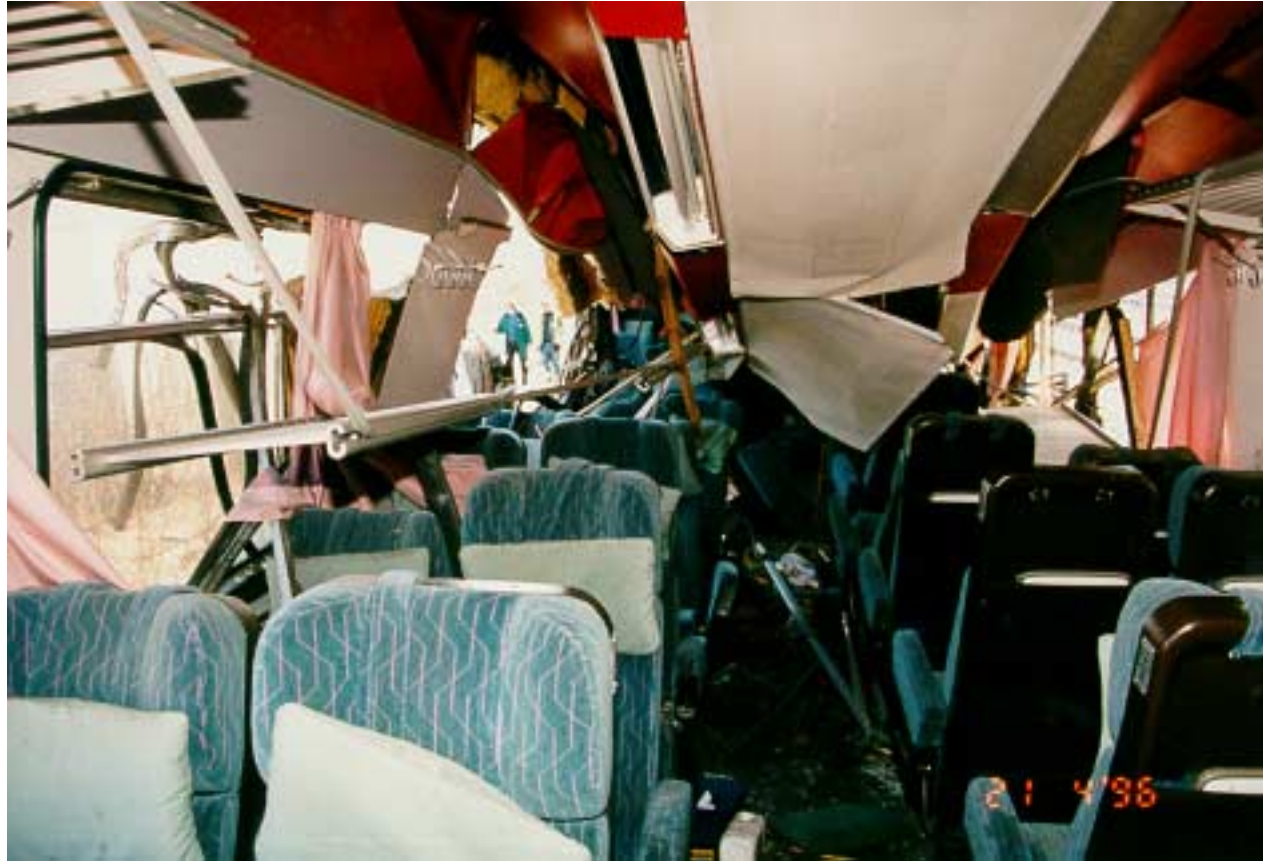
Kuva 14. Ensimmäisen vaunun vauriot myös sisällä olivat huomattavat. Vaunussa ei kuitenkaan kukaan loukkaantunut vakavasti. Vaunun sisäkattorakenteet osoittautuivat kiinnityksiltään heikoiksi.
