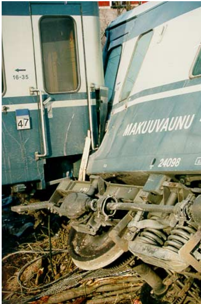
Kuva 17. Pelastautuminen päädyissä olevien ovien kautta oli mahdotonta, koska törmäyksessä ovet vioittuivat.
