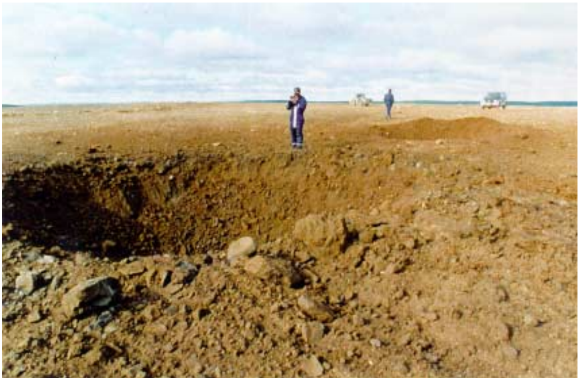
Räjähdyvälityskokeen aiheuttama kraateri. Kokeessa oli kaksi miinaa kuljetusalustallaan. Kraaterin halkaisija on 7,5 m ja syvyys 1,9 m.
