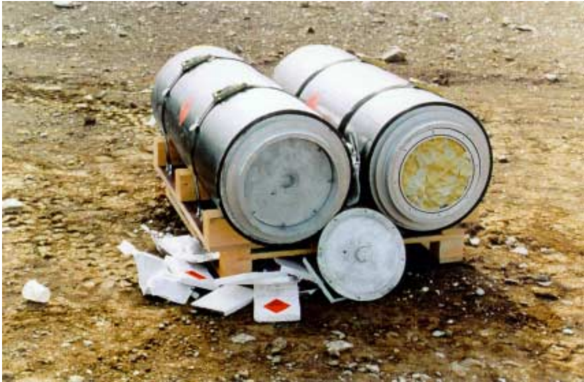
Toisessa kokeessa on kaksi miinaa kuljetusalustallaan. Miinojen väli on n 10 cm. Sytytys tapahtuu oikeanpuoleisesta miinasta.
