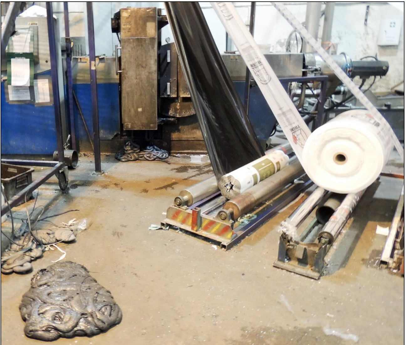
Kuva 10. Kuvassa taustalla on ekstruuderin, johon syötetään rullalla olevaa prosessihylkyä. Etualalla on tuotantokoneesta betonilattialle valutettua muovia. (Kuva: OTKES.)
