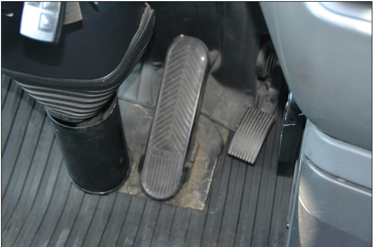
Kuva 8. Onnettomuusajoneuvoa vastaavan linja-auton polkimet. Jarrun vasemmalla puolella on ohjauspylväs. (Kuva: OTKES)
