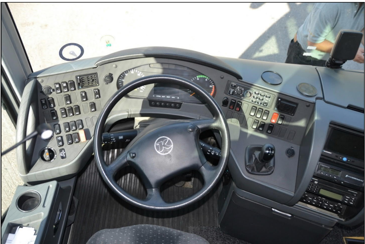
Kuva 9. Vastaavan auton hallintalaitteet. Hidastimen ja vakionopeussäätimen käyttövipu on ohjauspyörän oikealla puolella. (Kuva: OTKES)
