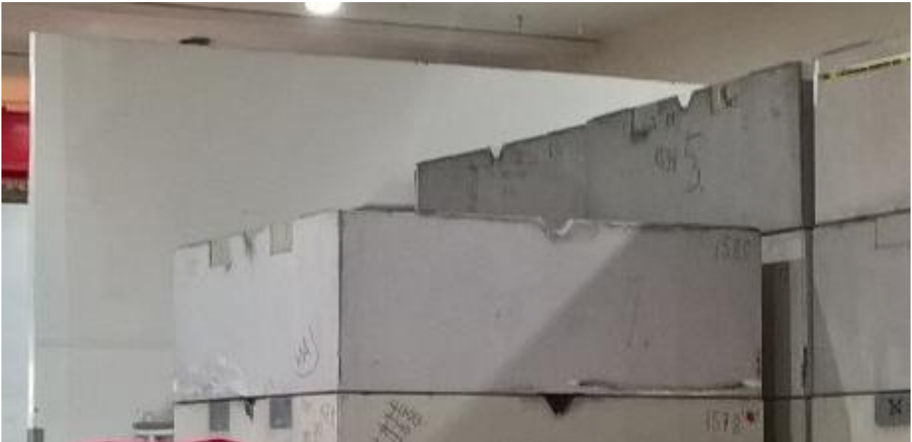
Kuva 14. Pienjätteiden betonilaatikko, jonka sisätilavuus on 5,2 m 3 . (Kuva: Teollisuuden Voima Oyj)
