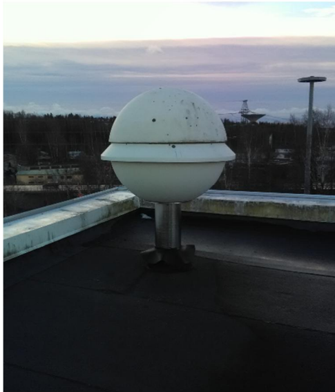
Kuva 5. STUKin katolla on hiukkaskeräin (ilmanottokorkeus 1 m) ja laboratoriotiloissa automaattinen hiukkasanalyysaattori (JL-500 Cinderella G2). (Kuva: STUK)
