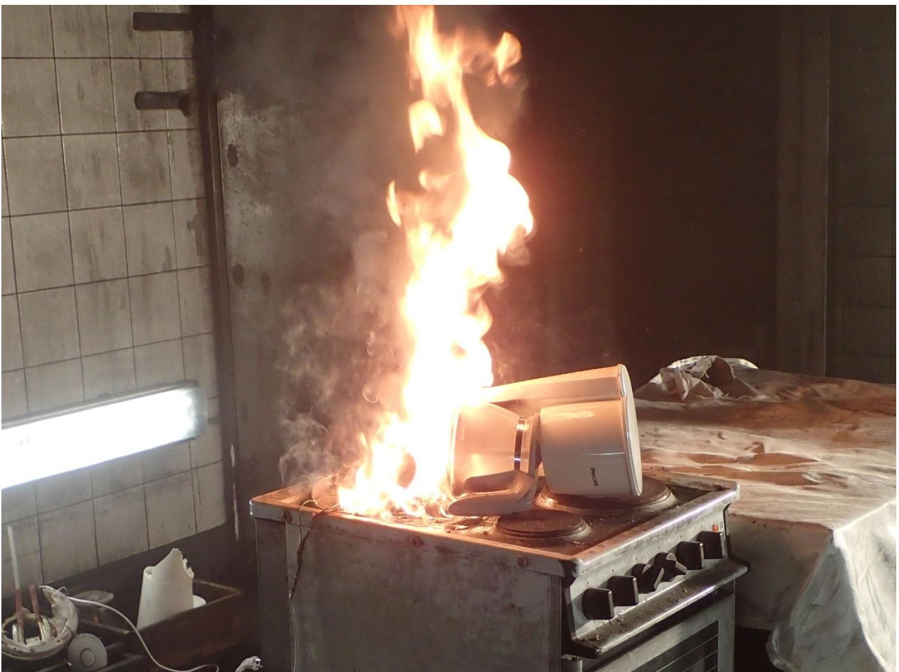
Kuva 9. Liedellä ollut kahvinkeitin syttyi polttokokeessa 11 minuutin kuluttua liedен päällekytkemisestä. Sen jälkeen palo jatkui siinä määrin voimakkaana, että yläkaapit voivat syttyä helposti. (Kuva: OTKES)
