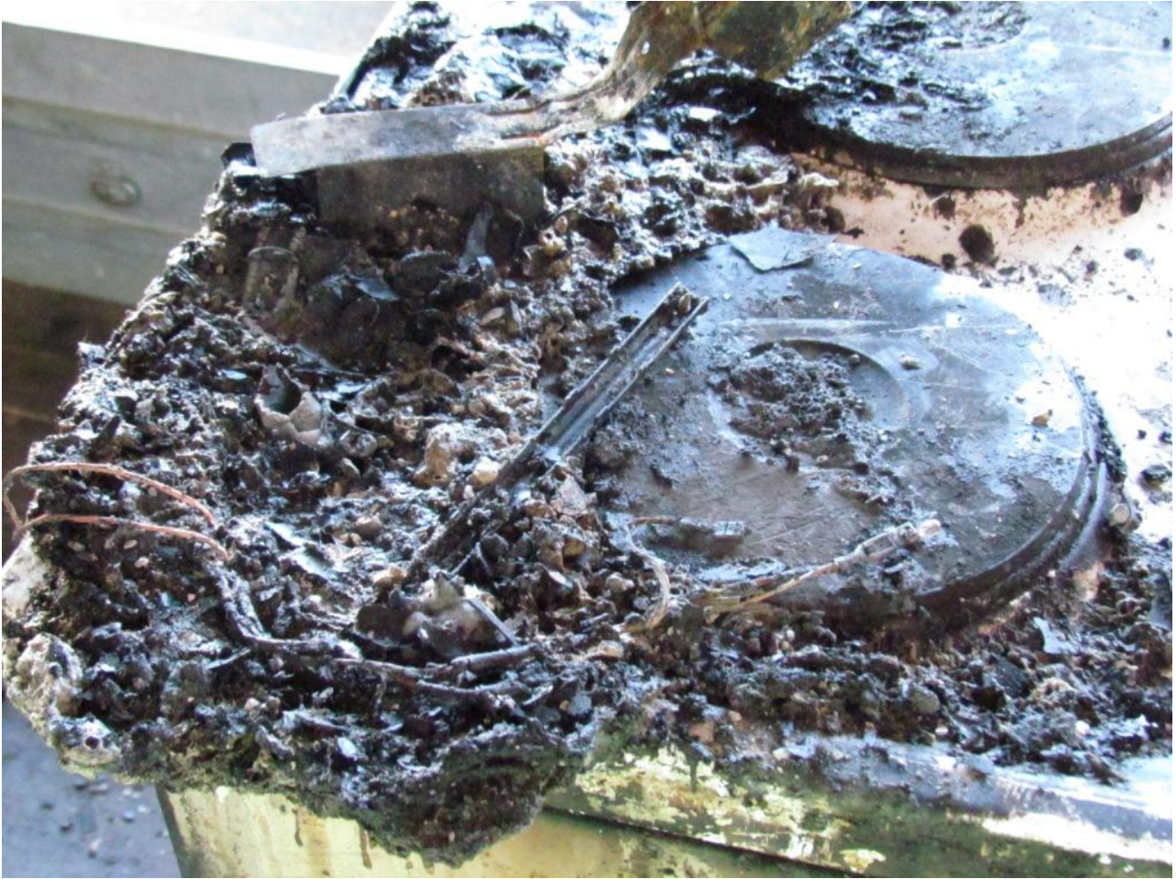
Kuva 1. Liedelle sulaneen kahvinkeittimen jäännökset. (Kuva: OTKES)
