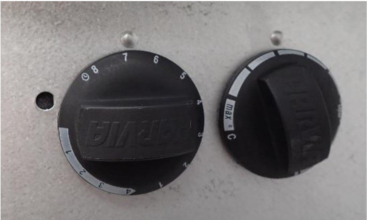
Kuva 5. Uuden samanmerkkisen kiukaan käyttökytkimet. Onnettomuushuoneistossa olleessa kiukaassa kytkimet olivat käänteisessä järjestyksessä. Kuvan vasemmassa laidassa oleva pieni aukko on ylikuumenemissuojan palautuspainike. (Kuva: OTKES)
