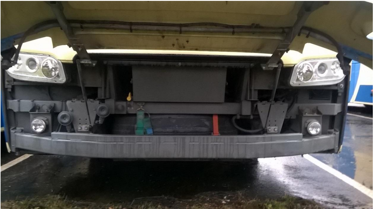
Kuva 11. Esimerkki keularakenteesta, joka on varustettu alleajosuojalla.
