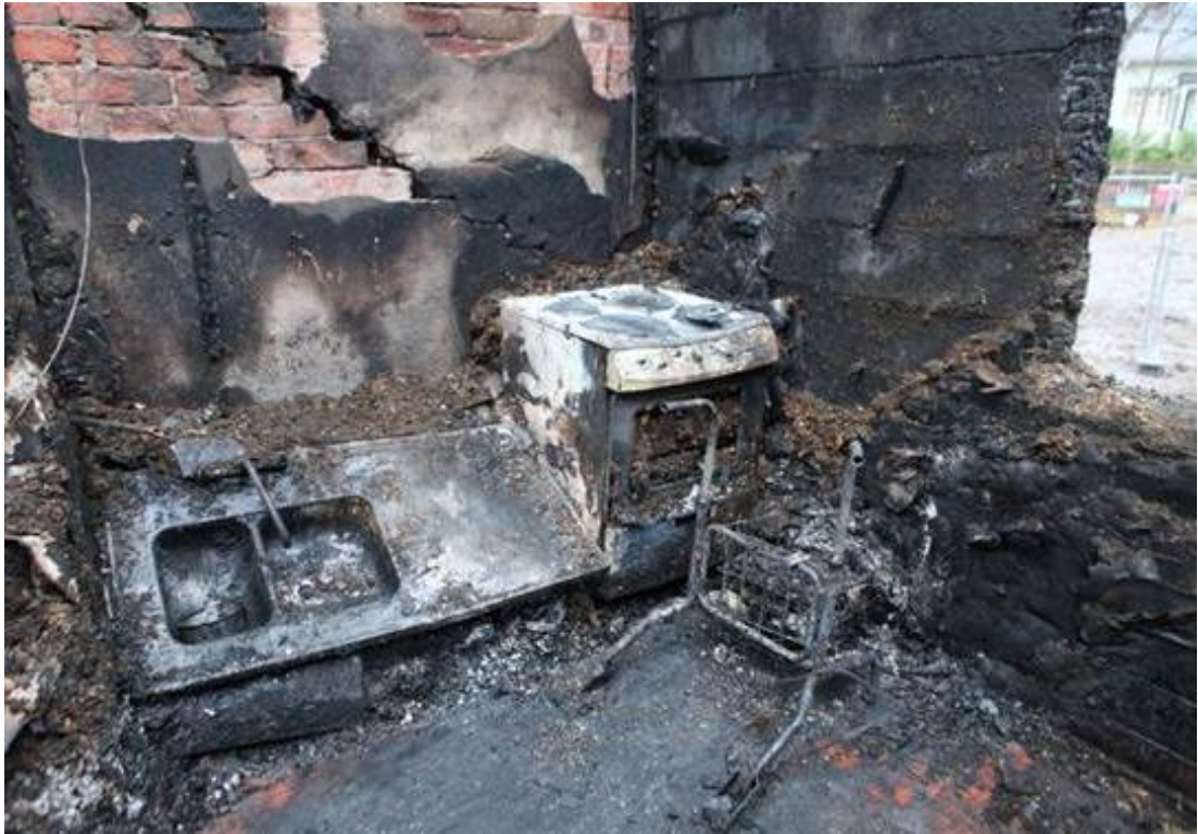
Kuva 4. Palon syttymispaikka asunnossa B raivauksen jälkeen. Palossa kuolleen henkilön käyttämä rollaattori löytöpaikassaan. Lieden oikeanpuoleisella etulevyyllä alumiinisen paistinpannun jäänteet. (Kuva: Poliisi)
