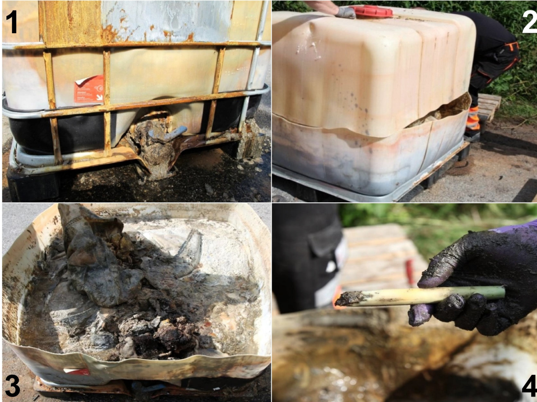
Kuva 8. Kuvasarja kontin tutkinnasta. 1) Kontin säiliön alaosaan oli sulanut reikiä, joista seosta oli valunut ulos. 2) Säiliö leikattiin auki. 3) Seoksen seassa oli kangassäkkejä. Kuumin kohta näytti olleen tyhjennyshanan kohdalla. 4) Seoksesta löytyneet osittain sulanut räjäytin. (Kuva: poliisi.)
