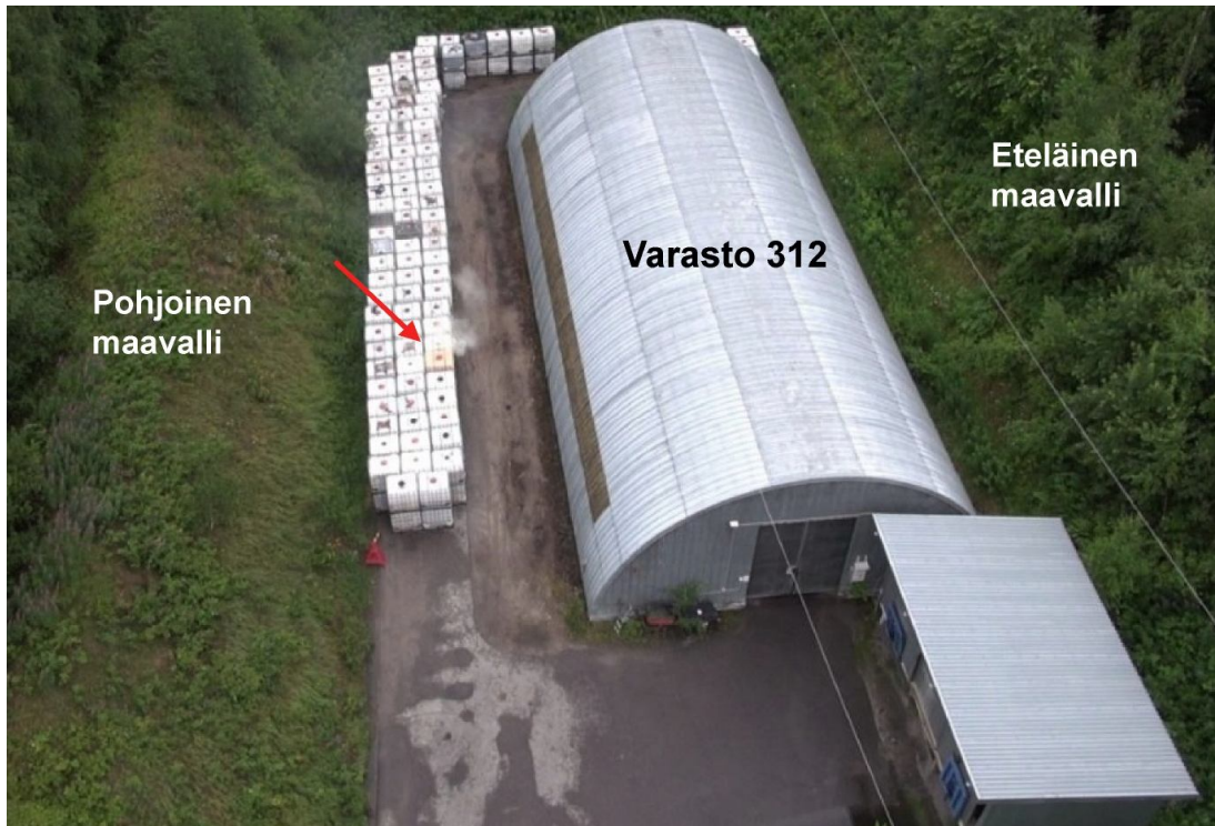
Kuva 3. Ruutukaappaus pienoishelikopterin aamuyöllä ottamasta videokuvasta. Yhdestä kontista nousi höyryä, ja kontin yläosan väri oli muuttunut. (Kuva: VideoDro-ne® Finland.)
