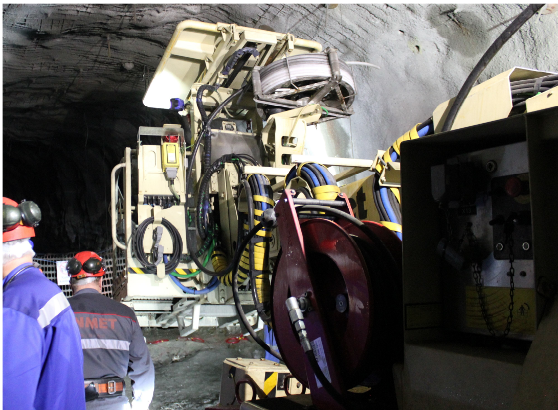
Kuva 7. Panostusajoneuvon etuosa. Puomi on vedetty sisään, jolloin puomin viereiset letkut ovat s-mutkalla. Puomin päässä on työskentelykori, jossa panostaja tekee panostuksen.
