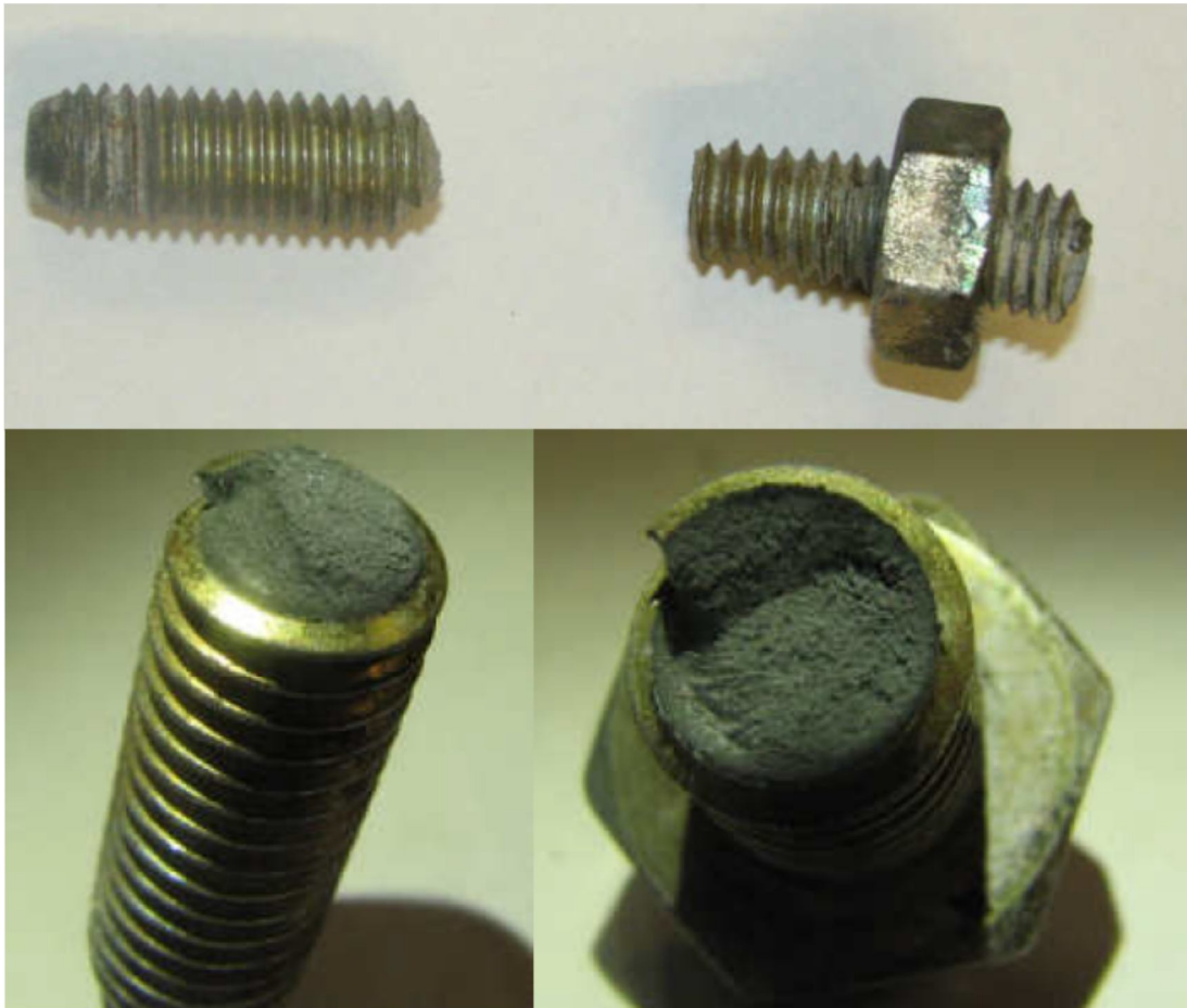
Kuva 4. Onnettomuuspaikalta talteen otettu katkennut kiila-ankkuri vetokokeen jälkeä. Mutteri ei ole kuvassa alkuperäisessä kohdassaan. Onnettomuudessa katkeaminen tapahtui betoniseinän ja lankun välisessä kohdasta, joka on yläkuvassa oikeassa reunassa. Kiila-ankkuriosaa ei ole, koska se jäi betoniseinään. (kuva: Lappeenrannan teknillinen yliopisto)
