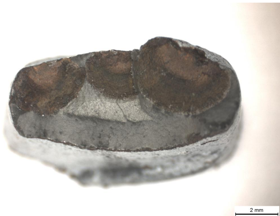
Kuva 5. Stereomikroskoopilla otettu kuva näytteen 3 vetokokeessa syntyneestä murtopinnasta..
