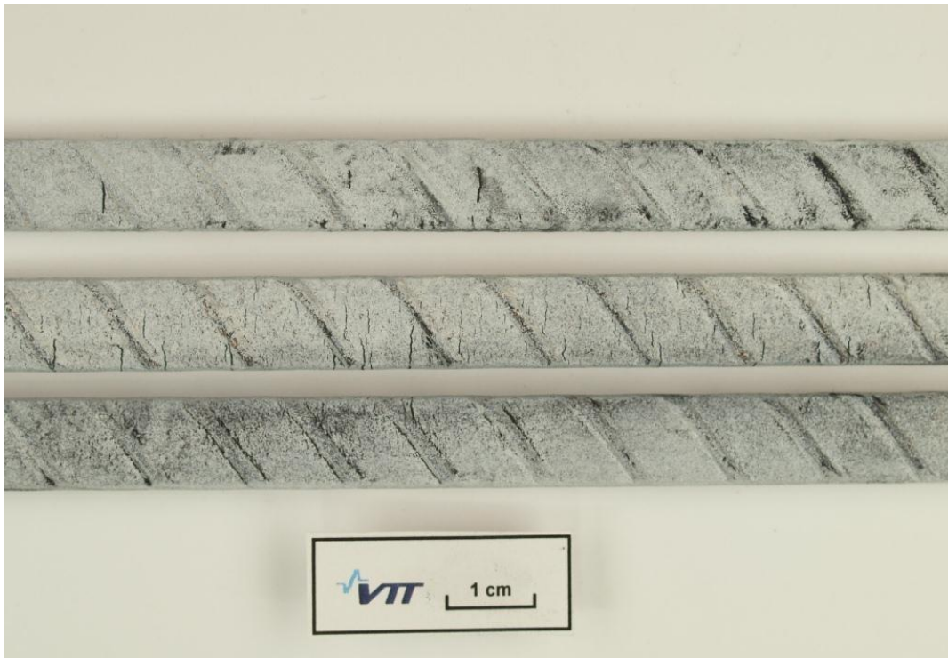
Kuva 4. Magneettijauhetarkastetut näytteet 2 (ylin), 3 (keskellä) ja 6 (alin).
