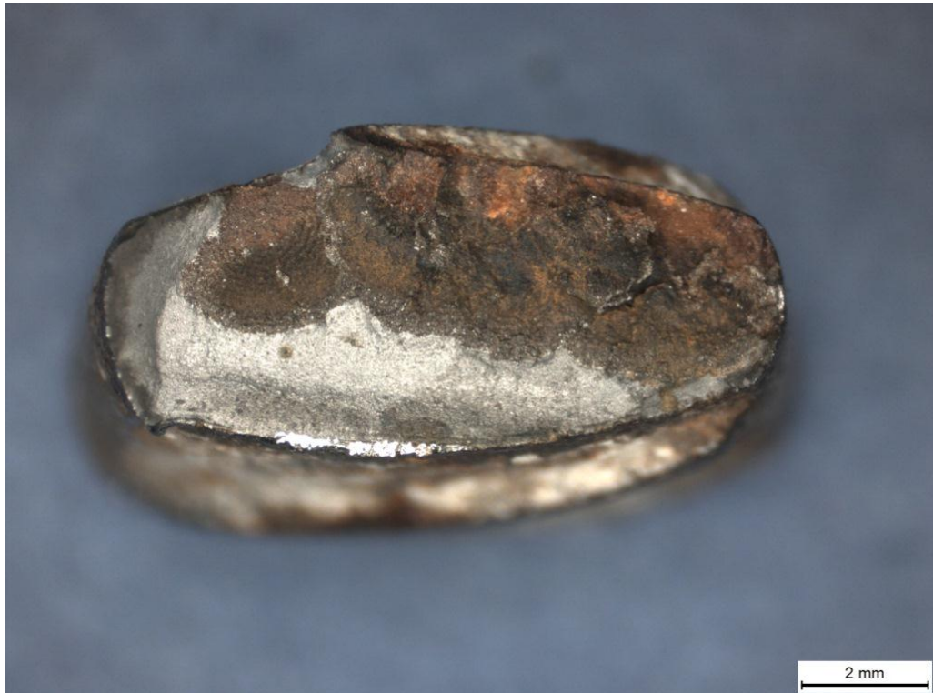
Kuva 7. Kuvassa 6 vasemmalla oleva murtopinta.
