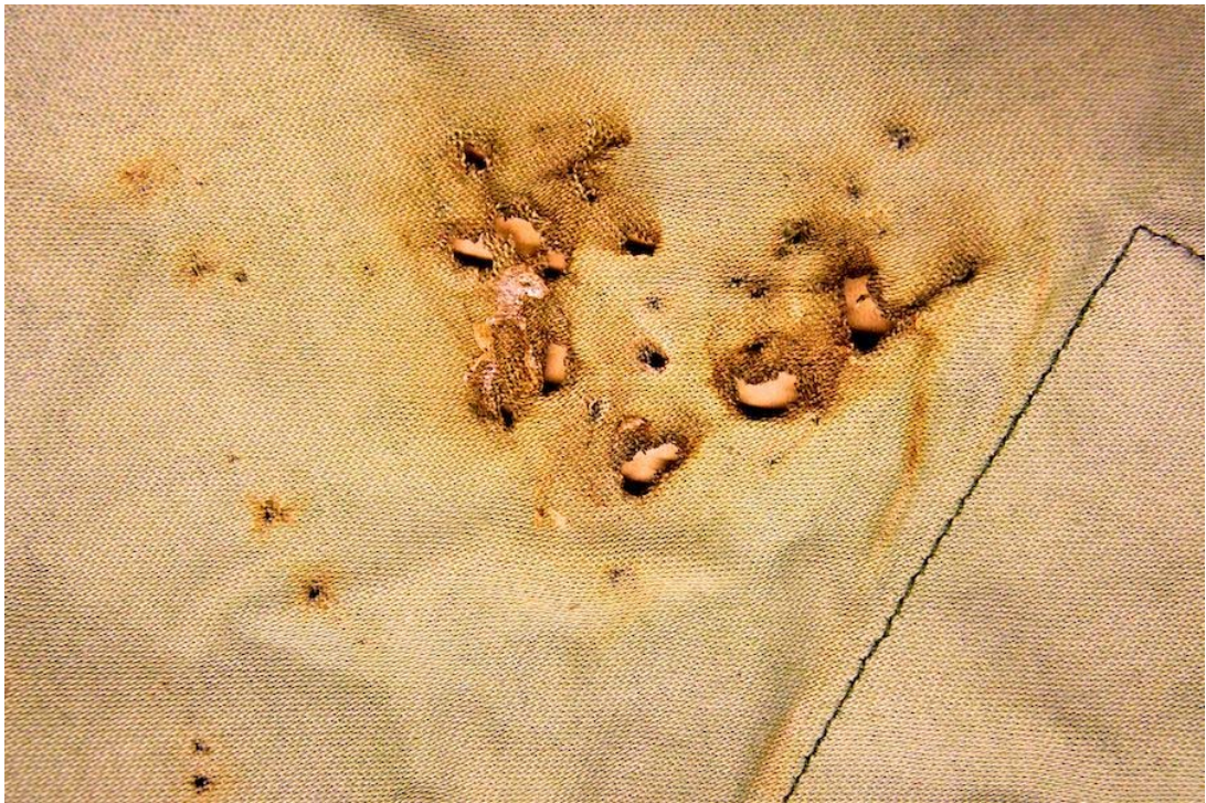
Kuva 9. Maastopuvun sisäpuolella olleita salamavirran aiheuttamia palojälkiä.
