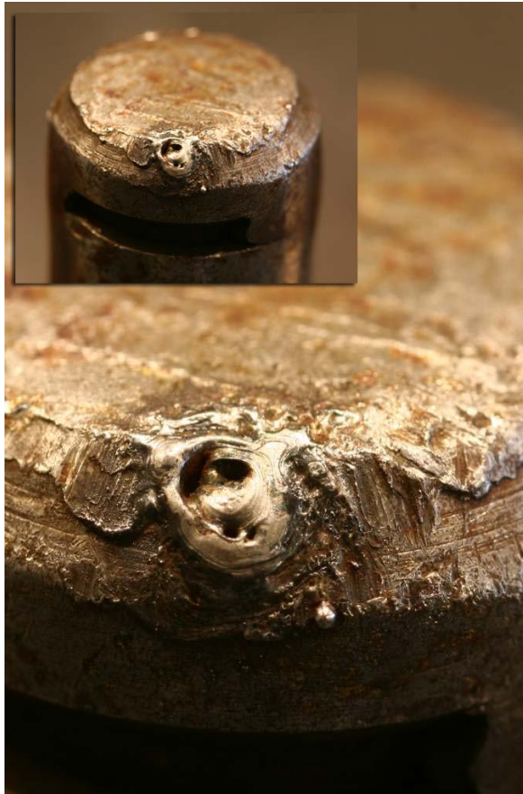
Kuva 5. Sähkövirran aiheuttama sulamisjälki teltan metallisen nurkkakepin yläosassa.
