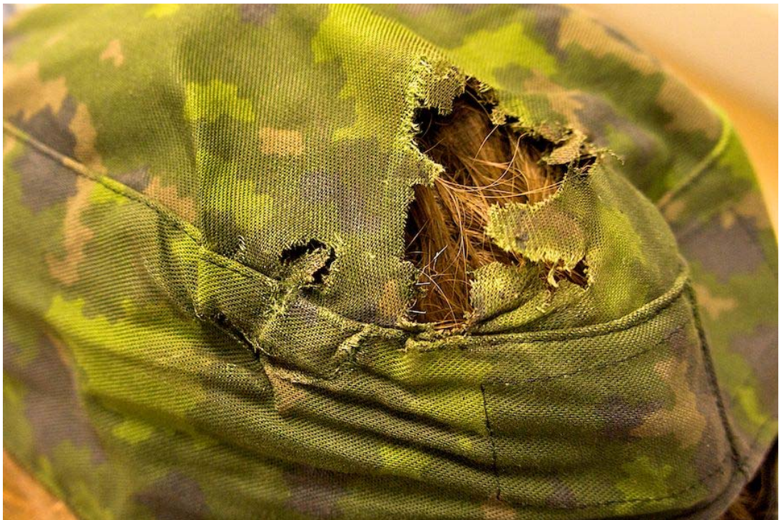
Kuva 8. Salamavirran aiheuttamat palojäljet lakissa.
