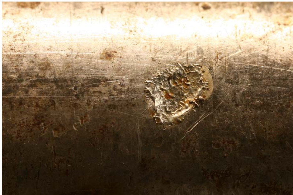
Kuva 6. Sähkövirran aiheuttama sulamisjälki teltan metallisen nurkkakepin alaosassa.
