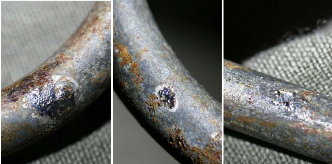
Kuva 7. Sähkövirran aiheuttamat kolme sulamisjälkeä teltan liepeessä olevassa metallisessa lenkissä.
