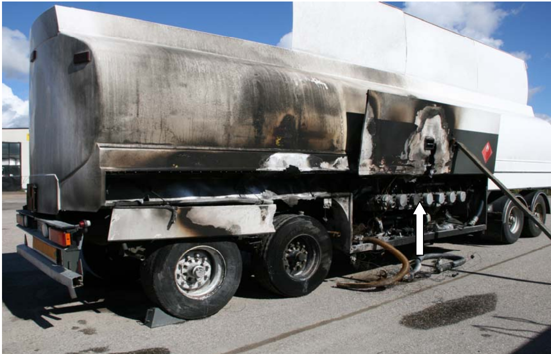
Kuva 2. Palo alkoi nuolella merkitystä kohdasta. Puhki palanut säiliö on sivuluukun reiän kohdalla.
