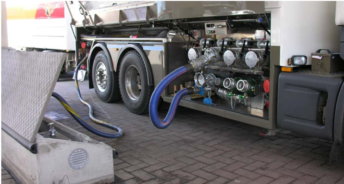
Kuva 4. Kaasunkeräysletku tulee takalaatikosta täyttölaatikkoon. Sen rinnalla maassa kulkee maadoituskelan maadoitin. Sininen letku on purkuletku, jonka toinen pää tulee säiliön purussa täyttölaatikkoon. Kuva ei liity tapaukseen.
