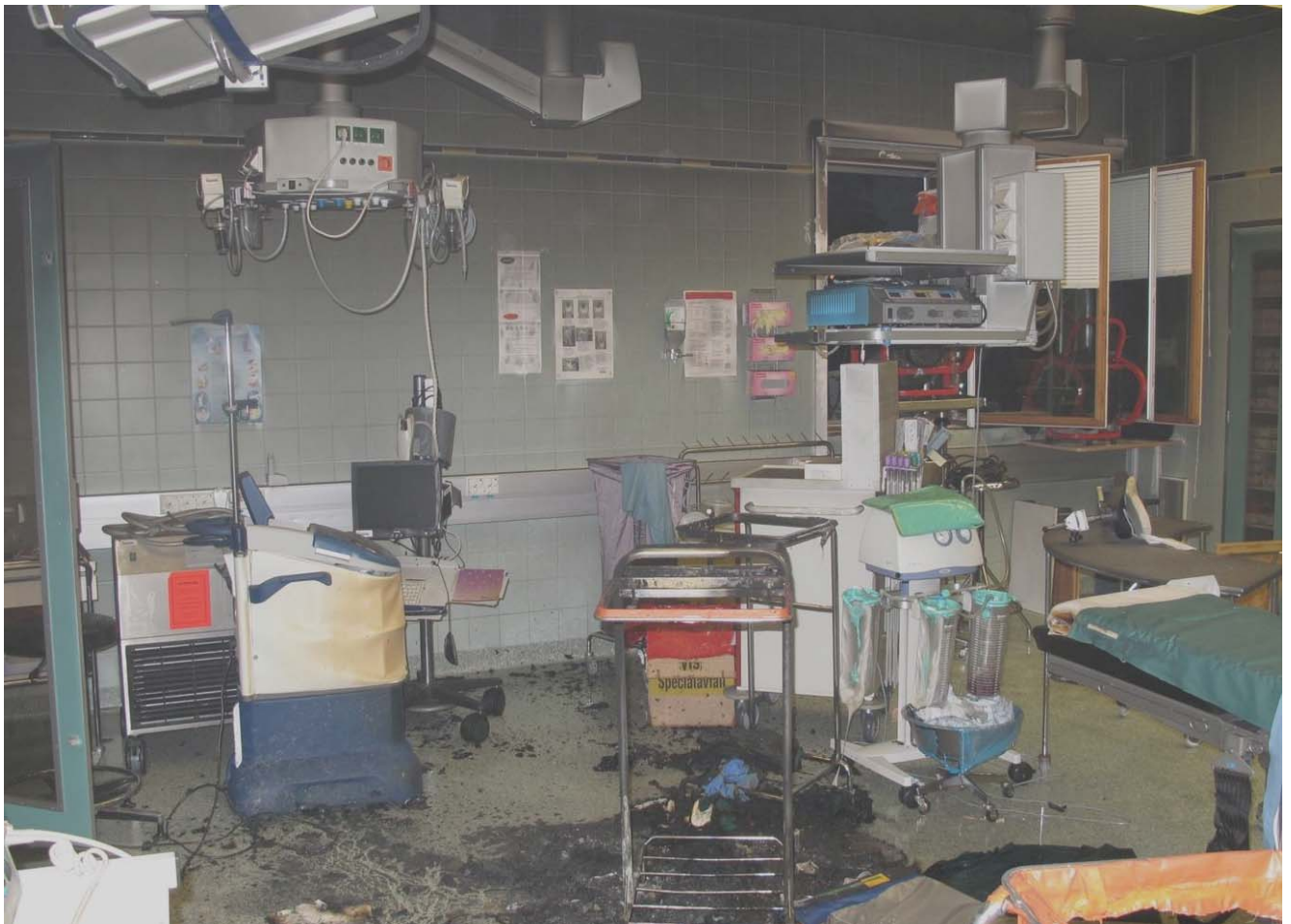
Kuva 2. Leikkaussalin 4 lattialla ovat palojäännökset, jotka ovat syntyneet etualalla telineessä olleiden roskasäkkien ja telineen pyörien palamisesta. (Kuva: Helsingin pelastuslaitos).
