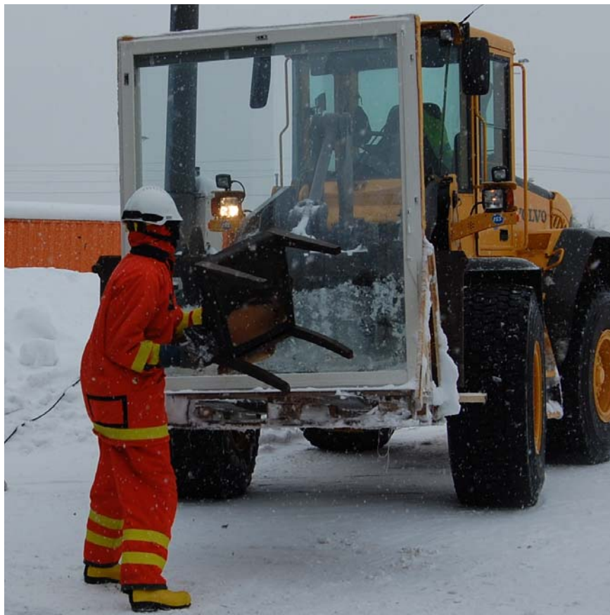
Kuva 15. Ensimmäinen isku ikkunan rikkomiskokeessa.
