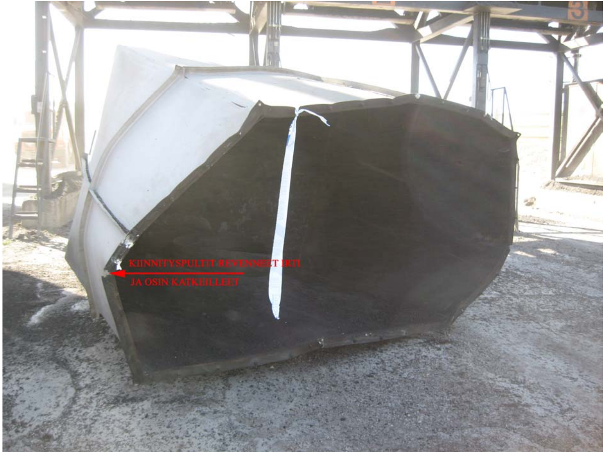
Kuva 3. Savukaasujen rauhoituskammio maassa
