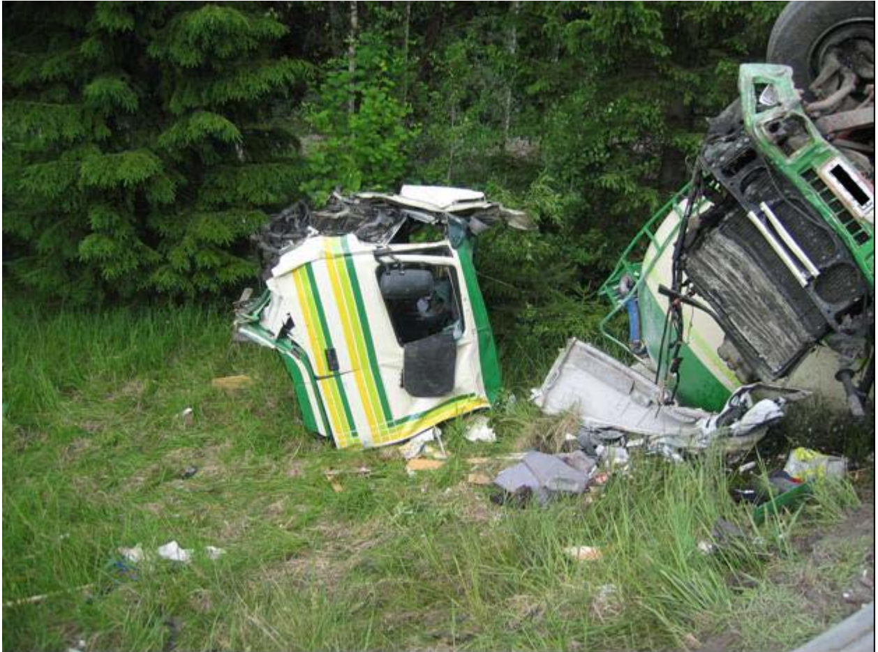
Kuva 2. Ajoneuvoyhdistelmän vetoauton ohjaamo irtosi ja kuljettaja putosi sen ulkopuolelle.
