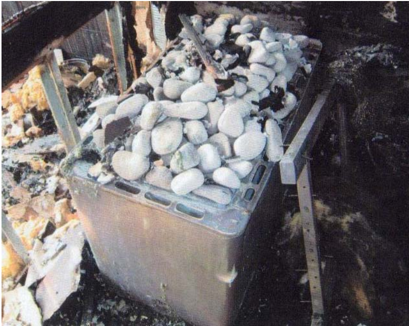
Kuva 1. Palaneen saunaosaston kiuas, puuosat ovat palaneet ja loput raivattu. Seinämien metalliset pystytuet ovat jäljellä. (Kuva: Helsingin poliisilaitos)
