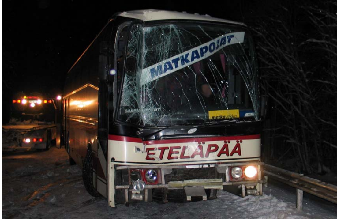
Kuva 5. Linja-auton F keulan saamat vauriot. Osumakohta E:n perävaunun oikeaan takakulmaan näkyy selvästi. (Kuva: pelastuslaitos)
